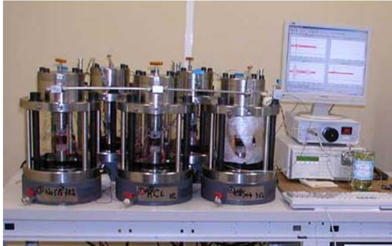
Figure 28 : a) Essais de fluage à contrainte constante (paliers successifs croissants). Chaque éprouvette (au total au nombre de 5) est soumise à une contrainte constante identique et à une hygrométrie différente. Chacune est équipée de deux capteurs d'émission acoustique permettant de suivre l'activité acoustique et de mesurer la vitesse des ondes.
