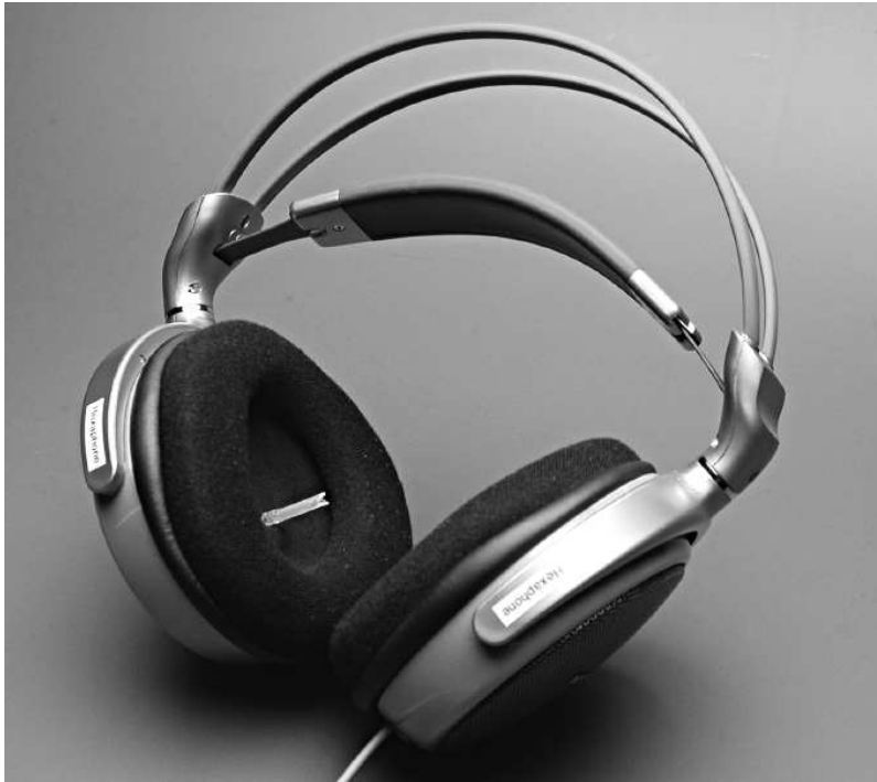
FIG. 2.7 : Modèle de casque actif. Un petit microphone est monté à l'extrémité du tuyau de silicone, l'autre bout venant se placer dans le conduit de l'oreille. (illustration tirée de [50])
