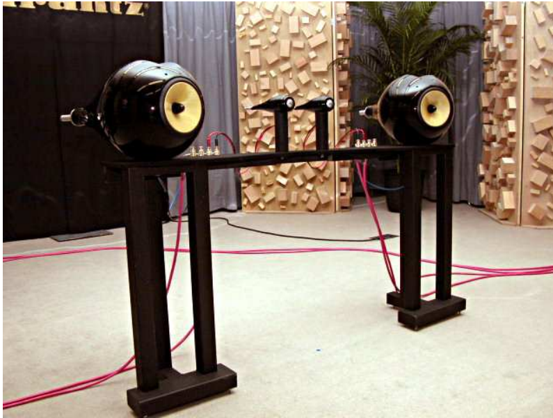
FIG. 1.4 : Exemple de dispositif de spatialisation sonore utilisant le principe de la distribution optimale des sources.
