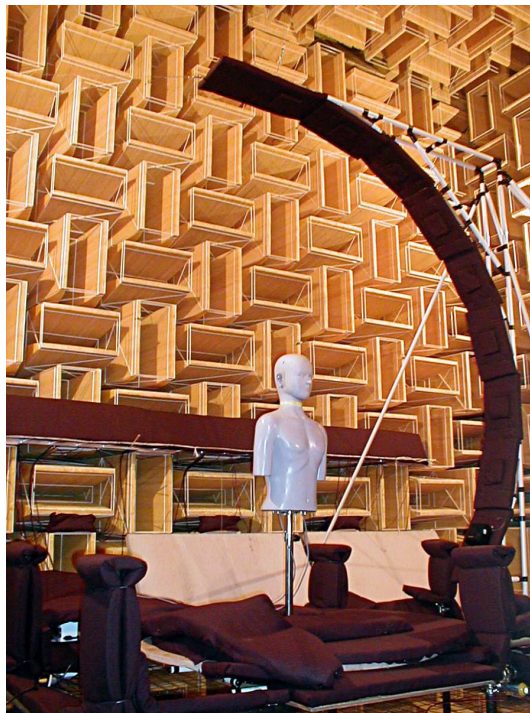
FIG. 1.2 : Mesure des HRTF d'un mannequin à l'université de Nagaoka (Japon). Des haut-parleurs sont disposés sur un arc de cercle dont la rotation permet l'enregistrement des HRTF pour un grand nombre de directions. Image issue de la page web http://audio.nagaokaut.ac.jp/hrtf/index_e.html
