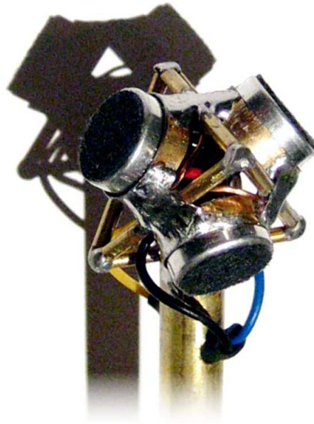
FIG. 1.5 : Un exemple de microphone soundfield pour la prise de son en format B. Ce modèle « artisanal » a été réalisé par Nick Mariette ( http://soundsorange.net/?projects:diy_ambisonic_microphone ).
