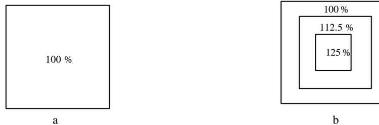
**Figure 55 : Etat d'autocontrainte homogène (a) ou progressif (b).**
