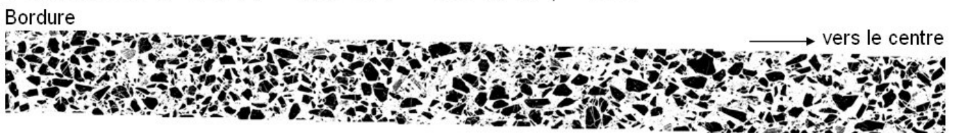
Figure IV.12 : Panoramas en section [YZ] dans des suspensions à 57% de cristaux d'alumine déformées en torsion. Dans ces sections la déformation est nulle au centre et maximale en bordure ( \gamma ). La fragmentation des cristaux augmente avec la déformation et pour les températures les plus basses (panorama 524).
