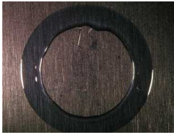
FIG. 7.13 – Photo d’un échantillon prise sur la plaque support juste après la rupture. L’expérience a été réalisée sur l’huile de silicones G20M, sur le pégosimètre Zwick pour une épaisseur h_0 = 200 \mu\text{m} et une vitesse de traction V = 0,15 \text{ mm/s} .
