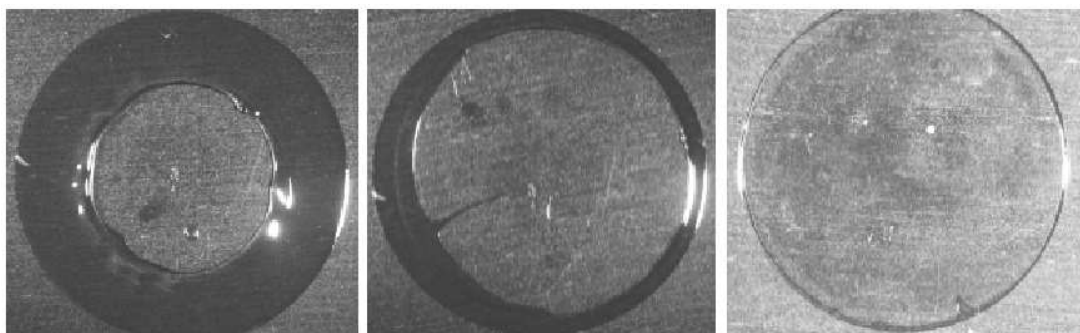
FIG. 7.18 – Photos de gouttes d'huile de silicones G20M obtenues après trois expériences de tack réalisées sur le pégosimètre Zwick pour trois vitesses de traction (de gauche à droite : V = 0,13 mm/s, V = 0,4 mm/s et V = 0,7 mm/s) avec une épaisseur de h_0 = 200 \mu\text{m} . La surface du joint (zone gris foncée), qui isole la cavité formée par les fractures interfaciales de l'extérieur, décroît à mesure que la vitesse de traction augmente.
