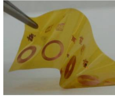
Figure II-21 : fabrication de résonateurs miniatures déposés sur Kapton® souple [53]
