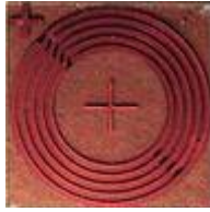
Figure II-20 : résonateur 5 tours, \varnothing moyen 12mm, en cuivre micromoulé déposé sur \text{LaAlO}_3
