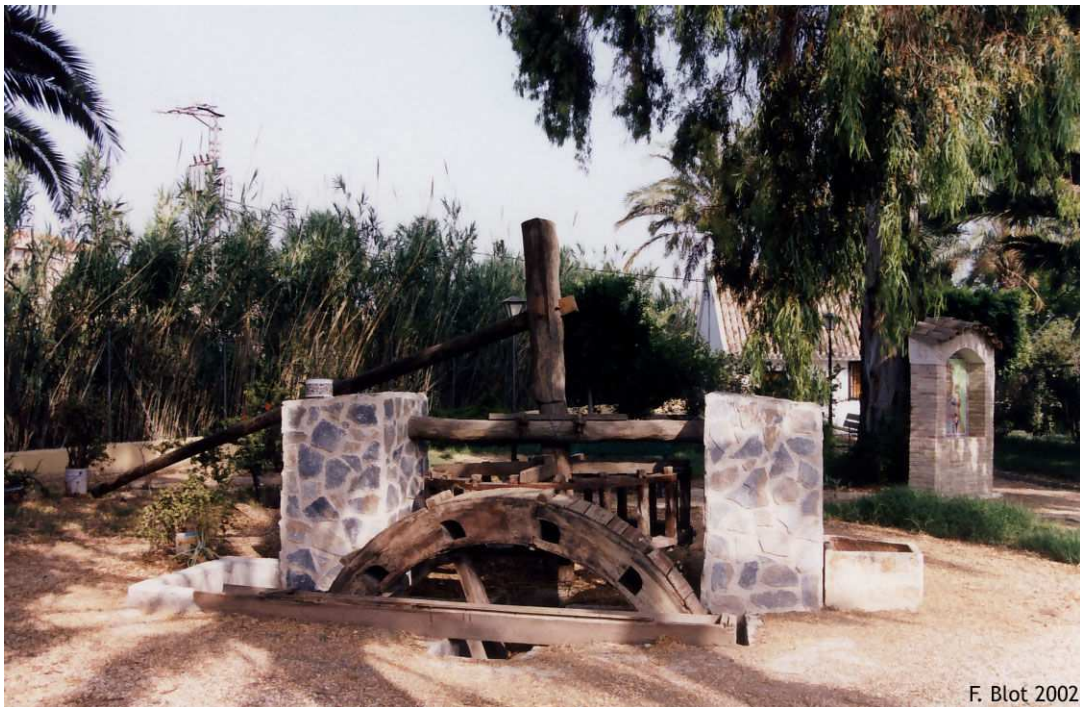
Figure 11 – Système de pompage mu par traction animale. Murcie
