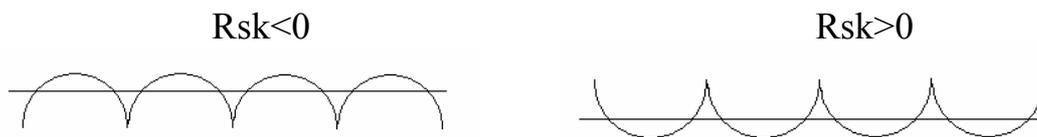
Figure (5-11) : représentation du profil  $R_{sk}$
