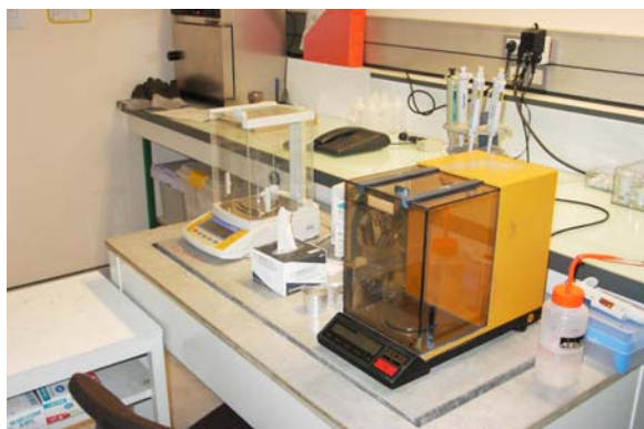
Figure 2.4. Balances électroniques dans la salle blanche du LGCA, Grenoble
