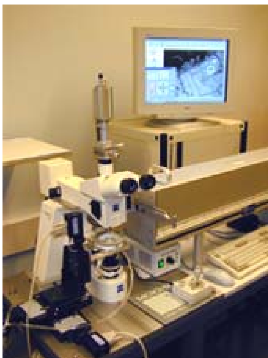
Figure 2.6. EXCIMER laser (193 nm) couplé à un Perkin-Elmer ELAN 6100 DRC ICP-MS. Lausanne Suisse
