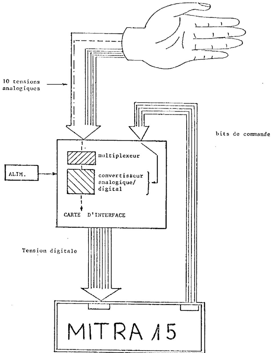
Figure 3.c - Schéma général Main-Interface-Calculateur
