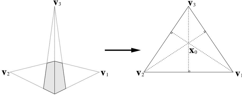
FIG. 6.2 – Relation entre les points de fuite et le point principal.
