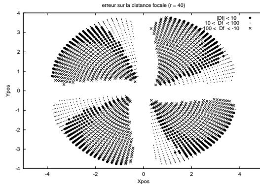
FIG. 7.8 – Erreurs sur la distance focale en fonction de la position de la caméra, lorsque la position du point principal a une erreur de +20 pixels sur  $u_0$  et -20 pixels sur  $v_0$ . Écarts inférieurs à 1% ( $\bullet$ ), écarts entre 1% et 10% positifs ( $\cdot$ ) et négatifs ( $\times$ ).
