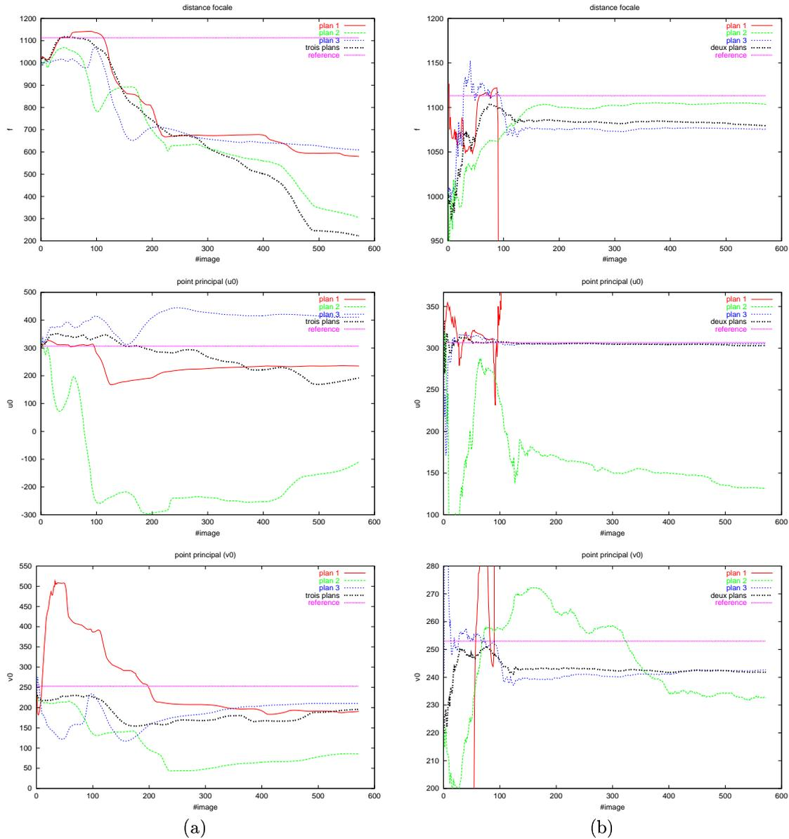
FIG. 7.11 – Paramètres intrinsèques obtenus avec la méthode de Noirfalise pour la séquence *Paysage*, lorsque les homographies inter-images sont calculées (a) de forme itérative ou (b) si la mise en correspondance des points de calibrage a été directement effectuée par rapport à la première image.
