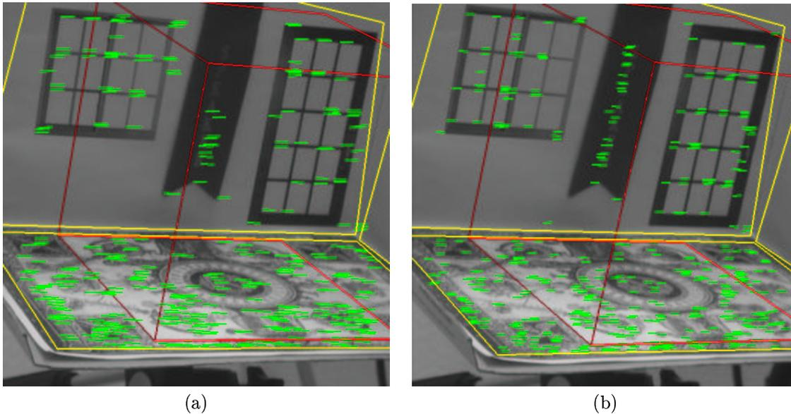
FIG. 3.2 – Exemple de déplacement des points d'intérêt d'une scène suite à deux types de mouvement différents : (a) une rotation panoramique et (b) une translation parallèle à l'axe  $X$  du plan image.
