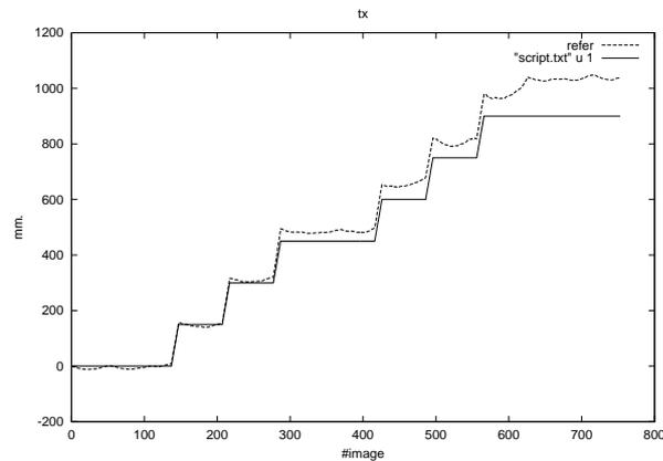
FIG. 3.3 – Comparaison entre l'estimation faite au moyen d'une méthode de recalage séquentiel [SB02a] et la valeur réelle d'une des composantes du point de vue ( $t_x$ ). L'écartement graduel entre les deux courbes met en évidence le problème de dérive des paramètres.
