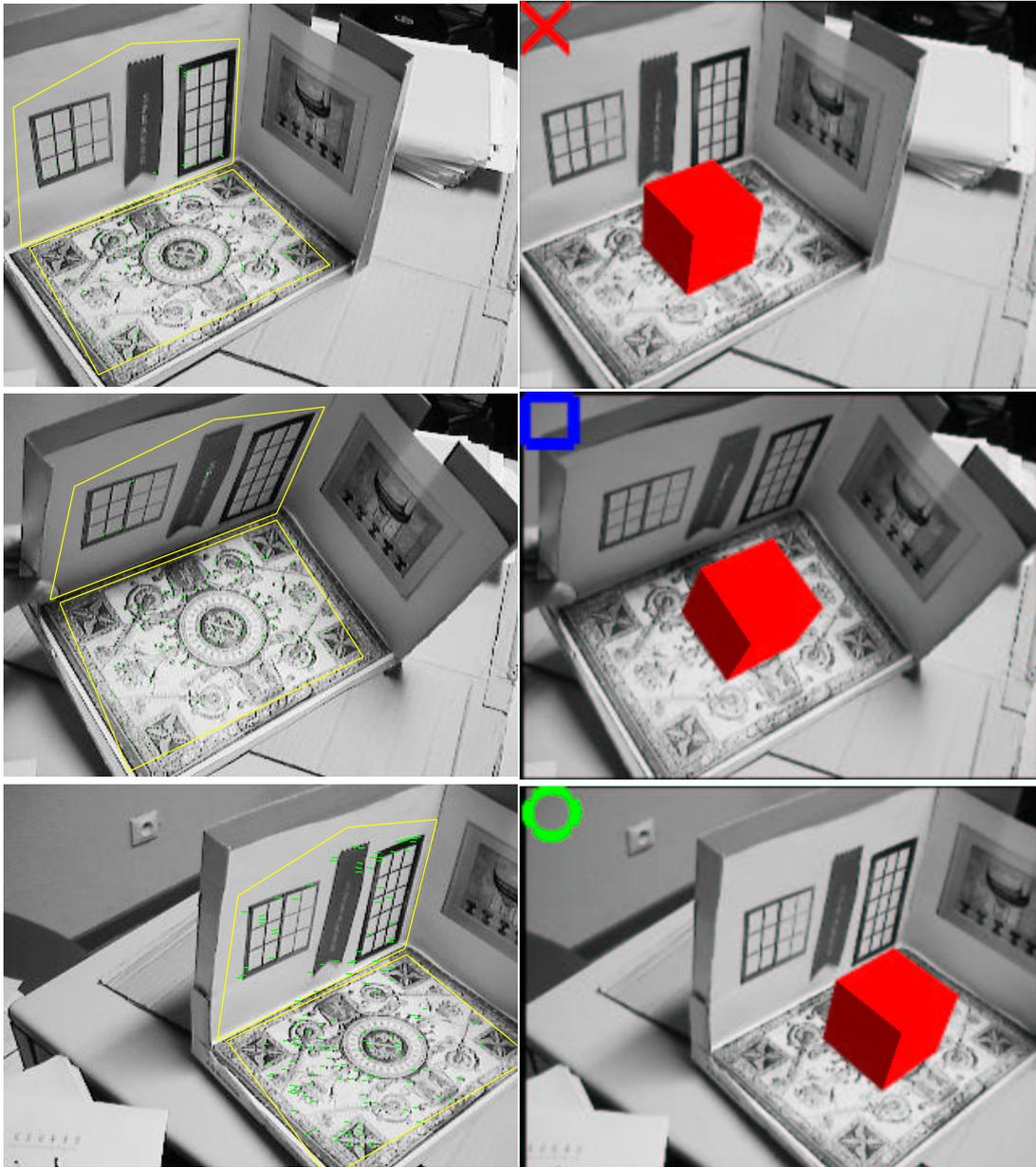
FIG. 4.12 – Quelques exemples de la scène augmentée. La première colonne montre le suivi des points dans les trois plans utilisés, la second colonne montre la scène augmentée.
