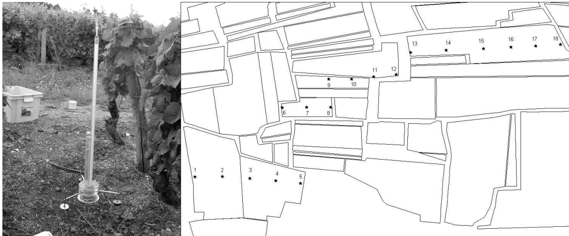
Figure A.4. L'infiltromètre à disque Trims dans un interrang à Vosne-Romanée. Sur la carte, la position des points de mesures le long du versant.
