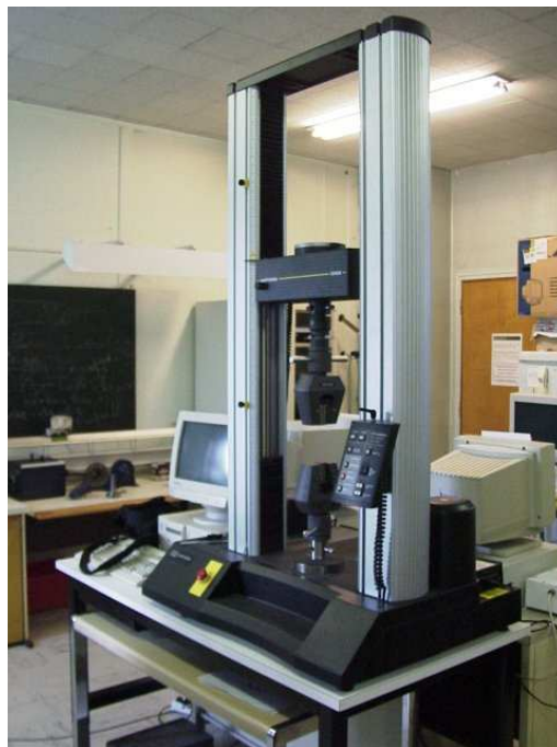
Figure 3 : Machine de traction de type Instron 50 kN utilisée pour la plupart des essais au laboratoire.
