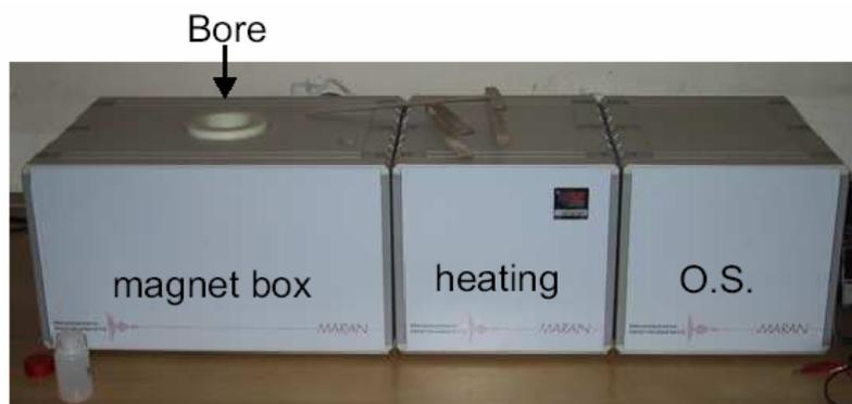
Figure 1-18. Spectromètre RMN Maran Ultra 2 MHz
