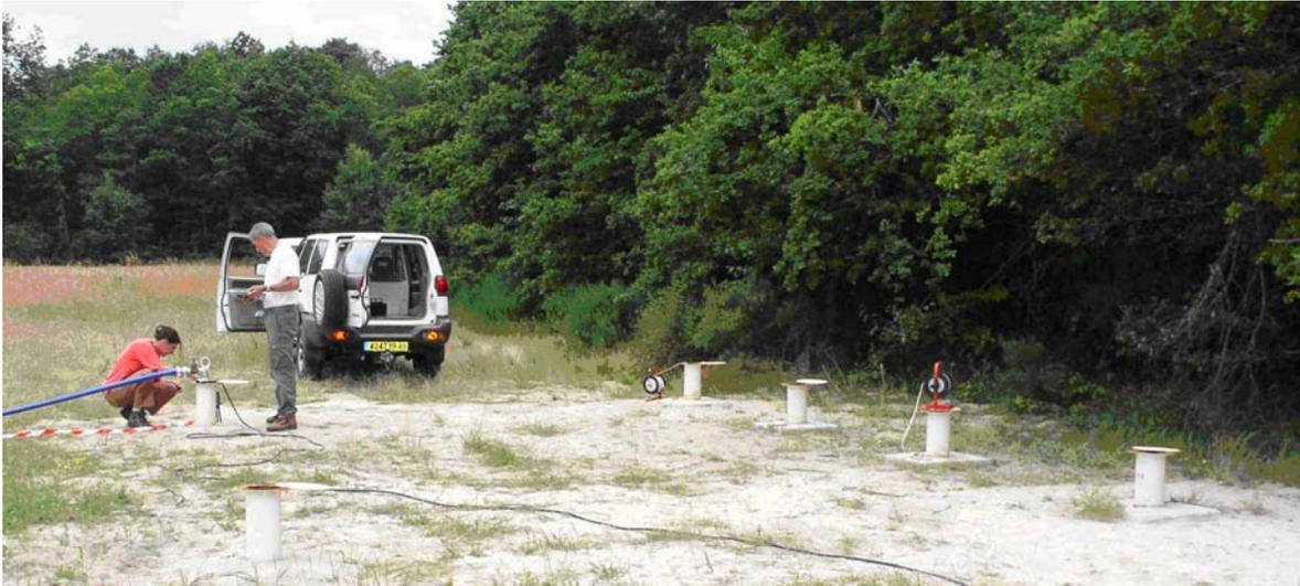
Figure 1-10. Mise en œuvre d'un essai de pompage
