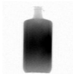
Figure 1-26. Exemple d'image IRM d'un flacon rempli d'eau
