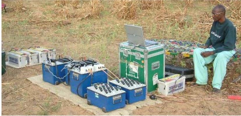
Figure 1-29. Equipement de Résonance Magnétique Protonique NUMIS<sup>PLUS</sup> sur site
