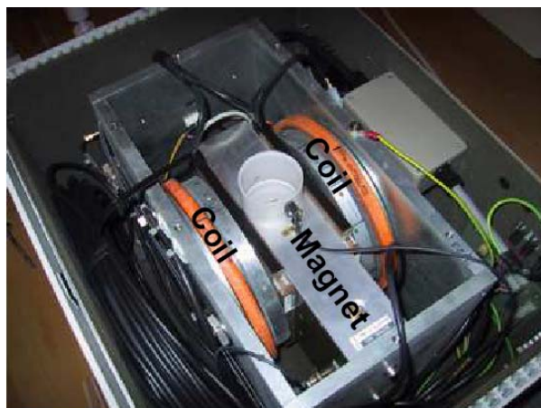
Figure 1-19. Vue à l'intérieur du Maran Ultra 2 MHz
