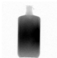
Figure 1-26. Exemple d'image IRM d'un flacon rempli d'eau Sur cette image l'eau apparaît en foncé (d'après Girard et al. 2005).
