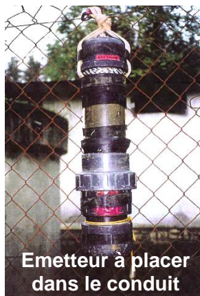
Figure 2-36. Balise électromagnétique utilisée pour le repérage du conduit karstique (D'après Muet, 2002)
