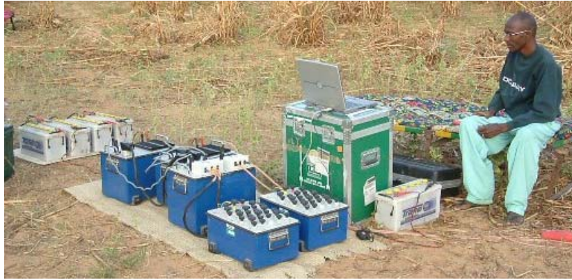
Figure 1-29. Equipement de Résonance Magnétique Protonique NUMIS PLUS sur site (Photo prise à Kolo Bossey au Niger en novembre 2006)
