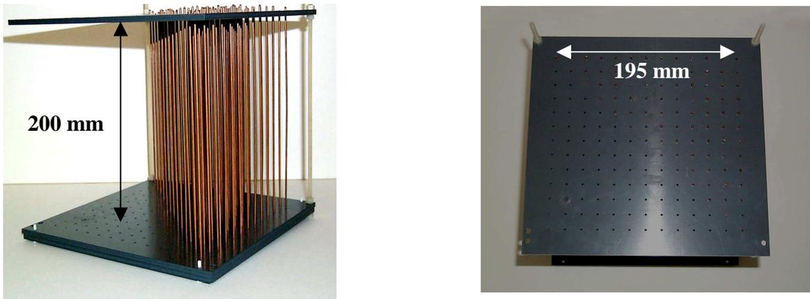
**Figure III:** Photo du prisme métallique. La figure a) montre la vue du côté du prisme et la figure b) montre la vue au dessus du prisme. La longueur de chaque côté est de 19,5 cm.
