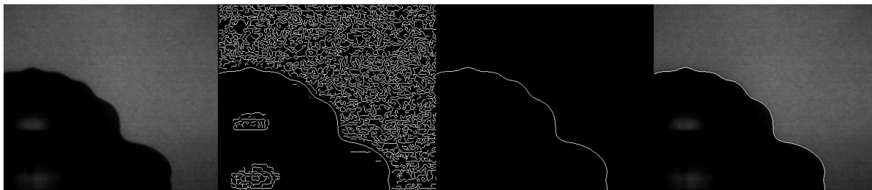
Figure II.19: Exemple de traitement d'image d'une macrogoutte.
