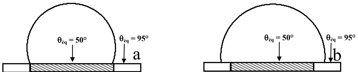
Figure IV.7 : Vues de côté schématiques des deux types d'état final lors de l'impact centré sur une surface mouillante (zone hachurée, \theta_{\text{eq}} = 50^\circ ) de forme circulaire entourée d'une surface non mouillante (zone blanche, \theta_{\text{eq}} = 95^\circ , dans le cas où l'étalement maximum est supérieur au diamètre du site mouillant
