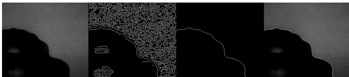
Figure II.19: Exemple de traitement d'image d'une macrogoutte.
