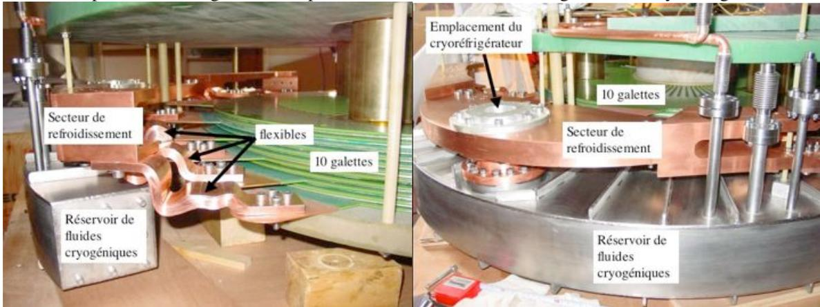
**Figure 5-10 – Essais des 10 galettes – Connexion thermique des galettes au cryoréfrigérateur**
