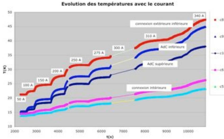
Figure 3-11 - Echauffements des connexions – configuration no 1
