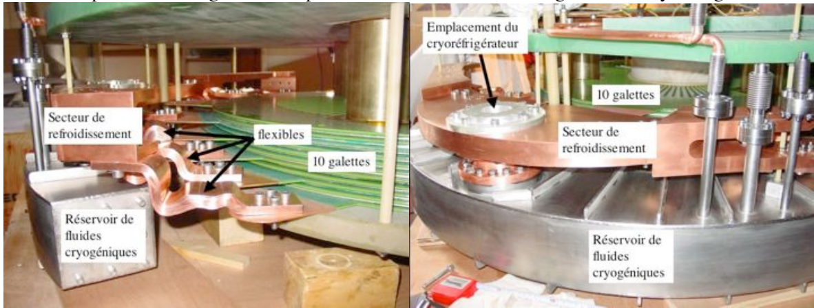
Figure 5-10 – Essais des 10 galettes – Connexion thermique des galettes au cryoréfrigérateur
