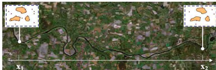
Figure 145 : Schématisation du transfert de particules entre les points x_1 (amont) et x_2 (aval) d'une rivière distants de L . La concentration en radioéléments entre x_1 et x_2 diminue suivant la loi de décroissance radioactive.
