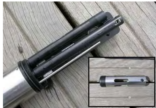
Figure 76 : Photo de la sonde de turbidité Troll 9000 Pro XP/e et de son cache de protection (4 cm de diamètre).
