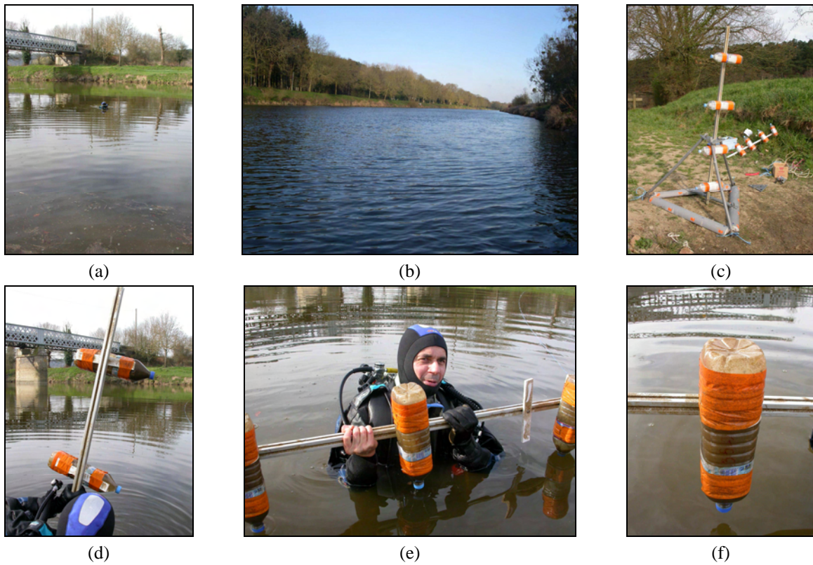
Figure 166 : (a) localisation de la section mouillée à l'amont du pont Saint-Marc ; (b) vue amont du site d'étude (portion rectiligne de la Vilaine sur 1,2 km) ; (c) exemple de support de pièges ; (d) positionnement des pièges dans la section mouillée par un plongeur ; (e) et (f) récupération des pièges et des sédiments qu'ils contiennent.
