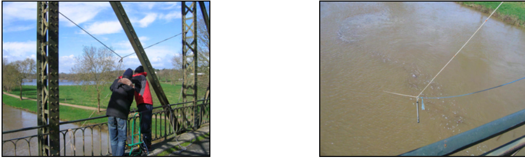
Figure 77 : Exemple de mise en œuvre du dispositif de poulie pour la mesure de turbidité depuis un pont.
