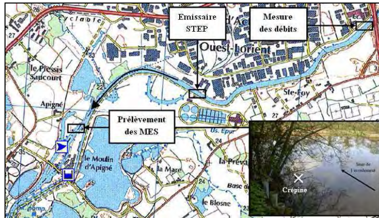
Figure 9 : Localisation sur carte IGN de la crépine de prélèvement des sédiments en suspension et de la station de mesure des flux d'eau. Distance entre les deux points de mesure : 2.75 km en linéaire de cours d'eau.
