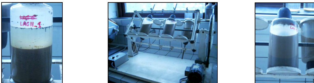
Figure 182 : Mise en œuvre de l'agitation mécanique.
