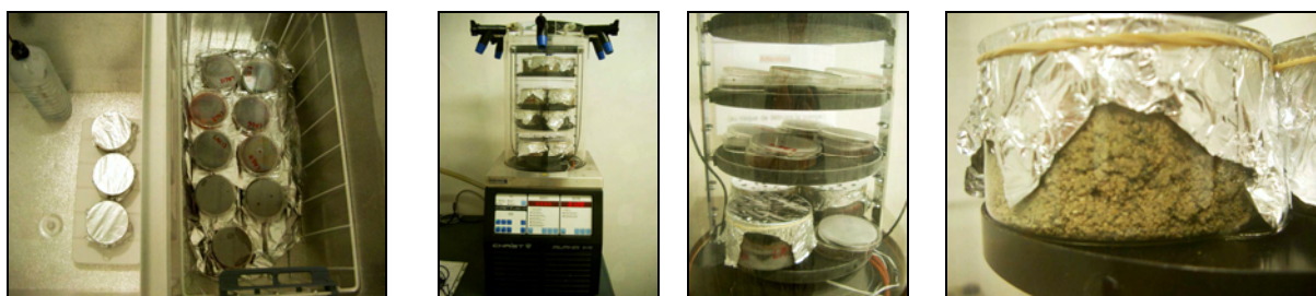
Figure 186 : Mise en œuvre de la lyophilisation. Durée de lyophilisation : 48 heures minimum à partir d'échantillons mis au congélateur pendant 12 heures (minimum).
