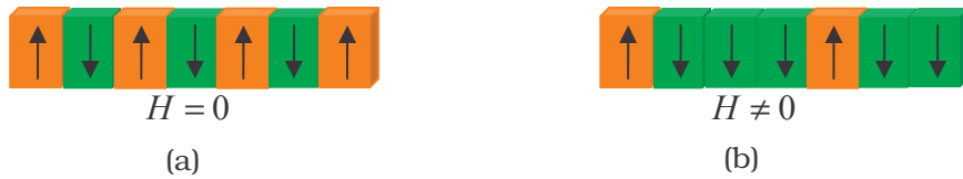
Figure 1.20 : Arrangement de domaines magnétiques parallèle a l'axe facile aimantation pour : (a) H = 0 , (b) H \neq 0 [LAC99].
