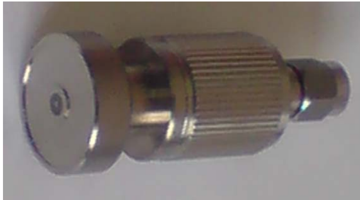
FIG. 1.7 – Sonde coaxiale pour la caractérisation électrique jusqu'à 20GHz
