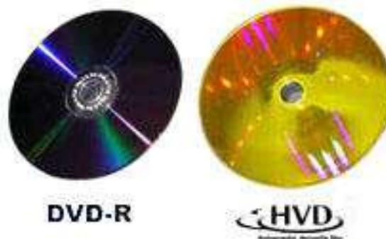
Le système utilise deux rayons laser de couleurs différentes, émis sur le même axe et dans la même direction. Le premier, un rouge pour lire des servo-informations (informations de contrôle), et un bleu ou vert pour lire les données holographiques. Une couche semi-transparente permet de filtrer les deux rayons, ne laissant passer que le rouge et réfléchissant le second : cela permet à chacun de lire les données qui lui sont destinées (fig.18).
