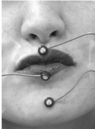
Figure 43 : Positionnement respectif des trois diodes (IREDS) pour la détection du déplacement en temps réel de la lèvre supérieure, inférieure et de la position du menton.
