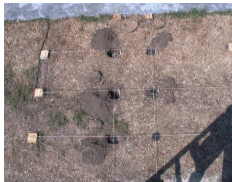
FIG. B.1: Scenario d'essais pour l'enregistrement des données MACADAM. Plusieurs mines antipersonnel ont été enfouies à différentes profondeurs dans un sol constitué de terre.
