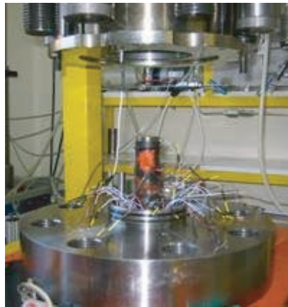
FIG. 3.9 – Photographie de l'échantillon mis en place dans la cellule avant connexion des fils.
