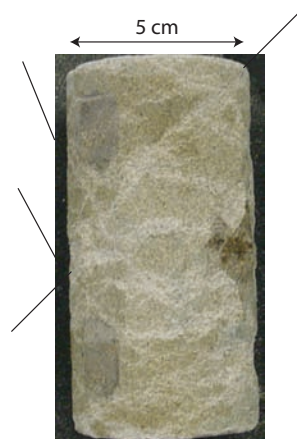
FIG. 6.12 – Photographie de l'échantillon Vo3 après déformation, pendant le premier cycle des bandes de compaction se sont formées (également prouvé par les émissions acoustiques). Pendant la montée de pression de pore des bandes conjuguées se sont créées coupant les bandes de compaction formées dans la première étape.
