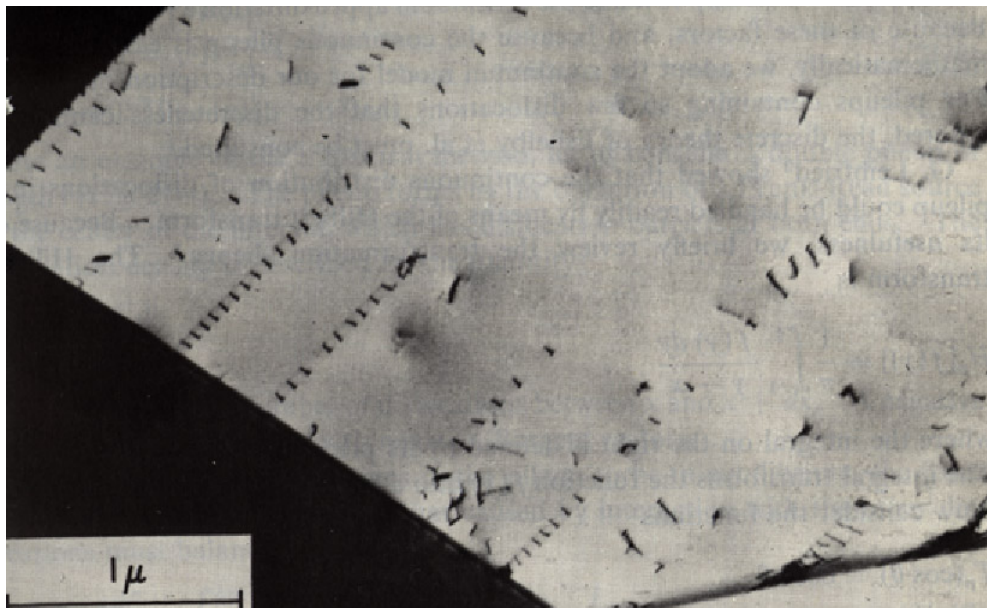
FIG. 7.1 – Empilement de dislocations à la frontière d'un grain d'alliage de cuivre et d'aluminium [Hirth et Lothe, 1968 75 ] (microscope à transmission directe, haute résolution).
