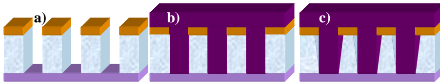
Figure 2.29 Microscopie à balayage : a) classique b) avec encapsulation c) technique de décoration
