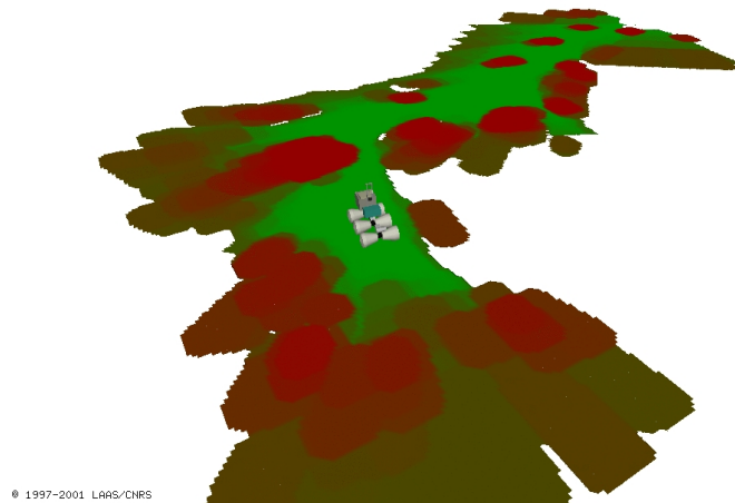
FIG. 3.1: Carte probabiliste de traversabilité établie par un robot terrestre à partir de données 3D fournies par stéréovision. La probabilité de traversabilité est codée en couleurs, selon une échelle traversable/vert à obstacle/rouge.
