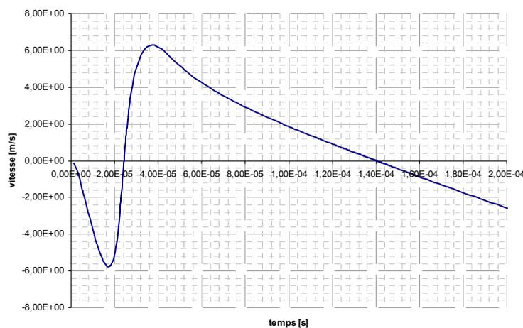
**figure 3-14 : Vitesse de l'interface eau/vapeur du cas standard**
