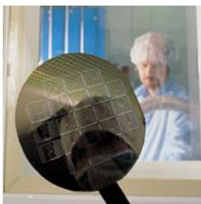
Figure A-05 : Wafer avant découpe des puces
