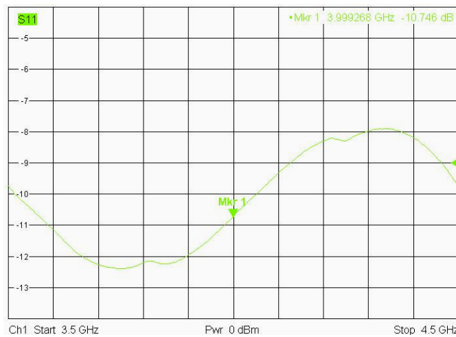
Figure 4.99 : Adaptation de l'entrée de l'horloge.
