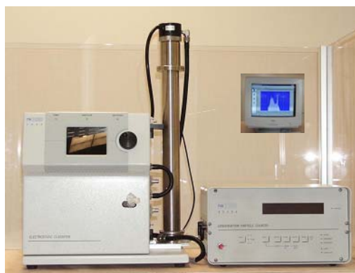
Figure 4-6 : SMPS (Modèle TSI3080) : Caractérisation des propriétés granulométriques de l'aérosol.
