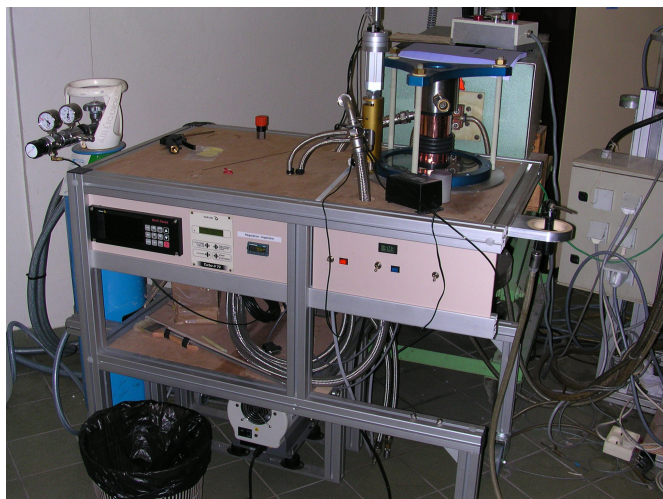
Figure 2.13. Four à induction électromagnétique du Laboratoire Louis Néel.
