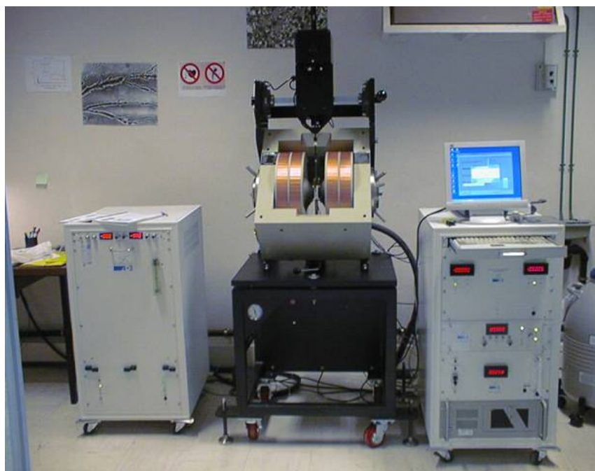
Figure 2.19. Vue générale d'un magnétomètre à échantillon vibrant (ou Vibrating Sample Magnetometer VSM). A gauche se trouve l'alimentation en courant continu des bobines d'Helmholtz induisant le champ magnétique appliqué, au centre le VSM en lui-même et à droite la console permettant de paramétrer la ou les mesures magnétométriques et l'acquisition des mesures.
