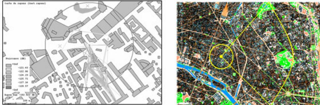
Figure 64 : Tracé des rayons dans une petite zone de 500x700 m<sup>2</sup> (à gauche), Cartographie avec le logiciel GRIMM sur une zone 5 km<sup>2</sup> (à droite)
