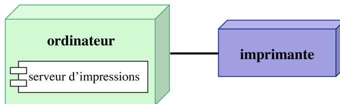
FIG. 2.2 – Représentation d'une association de communication en UML. Cette association représente un ordinateur composé d'un serveur d'impression relié à une imprimante.
