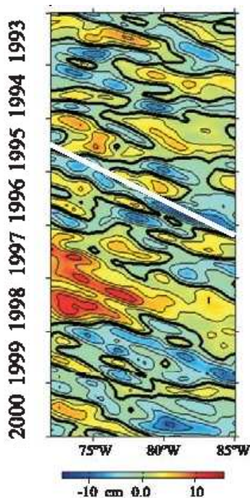
Figure 1.10: Série temporelle à 30°S du niveau de la mer (TOPEX-ERS). Un filtre passe-bas a été appliqué et la ligne blanche représente la vitesse de phase théorique du premier mode des ondes de Rossby (d'après Pizarro et al [2002])
