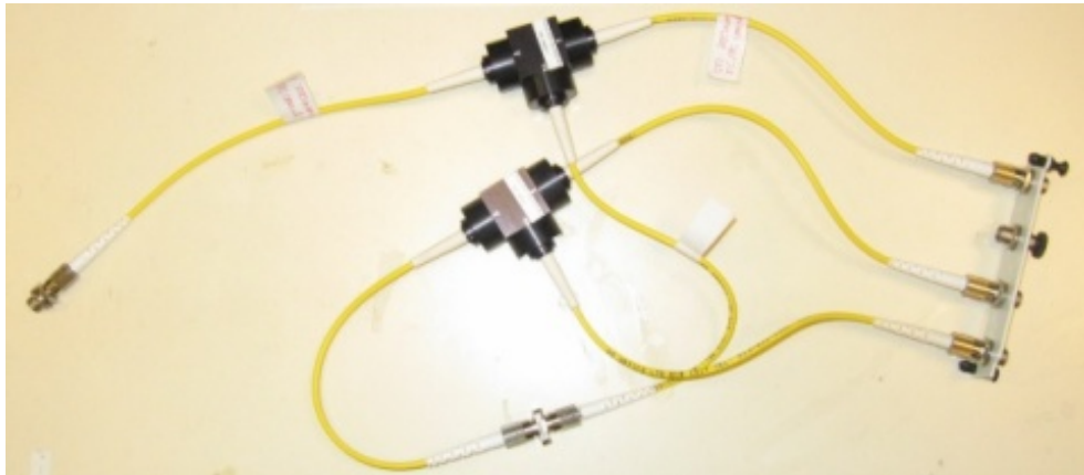
FIG. 4.16 - Système fibré de séparation des faisceaux à 780 nm .
