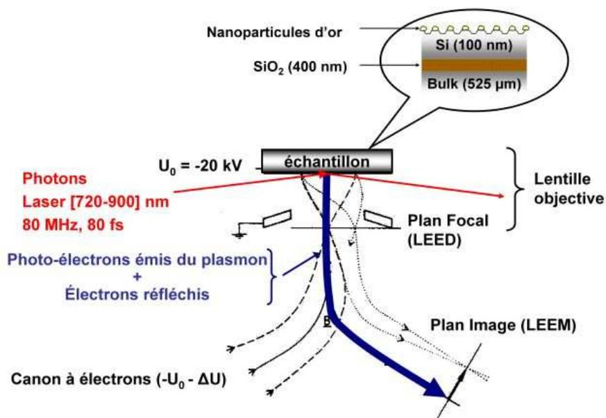
**Figure V-26 : Représentation schématique de l'instrumentation du PEEM-LEEM avec le tracé des différents chemins des électrons provenant soit de la source à électrons, soit des photo-électrons générés par photo-émission.**
