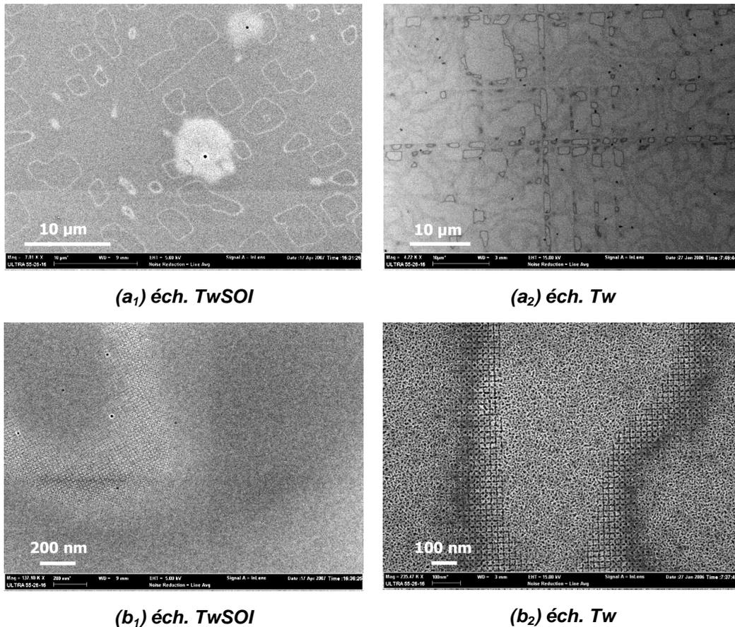
**Figure III-31 : Observations MEB de la structuration de surface ( $\Lambda = 20$  nm) après 5 minutes de gravure Dash obtenue sur un échantillon TwSOI (a<sub>1</sub> – b<sub>1</sub>) et un échantillon Tw (a<sub>2</sub> – b<sub>2</sub>) pour différentes tailles de balayages.**
