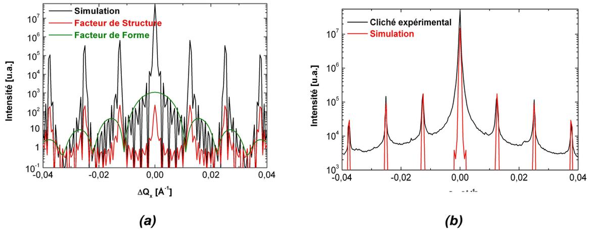
**Figure III-52 : (a) Simulation du facteur de forme (en vert), du facteur de structure (en rouge). La courbe noire présente le produit  $FxS$ . (b) Le signal GIXRD expérimental (courbe noire) et le signal simulé avec  $b = 48$  nm et  $h = 3$  nm (courbe rouge).**
