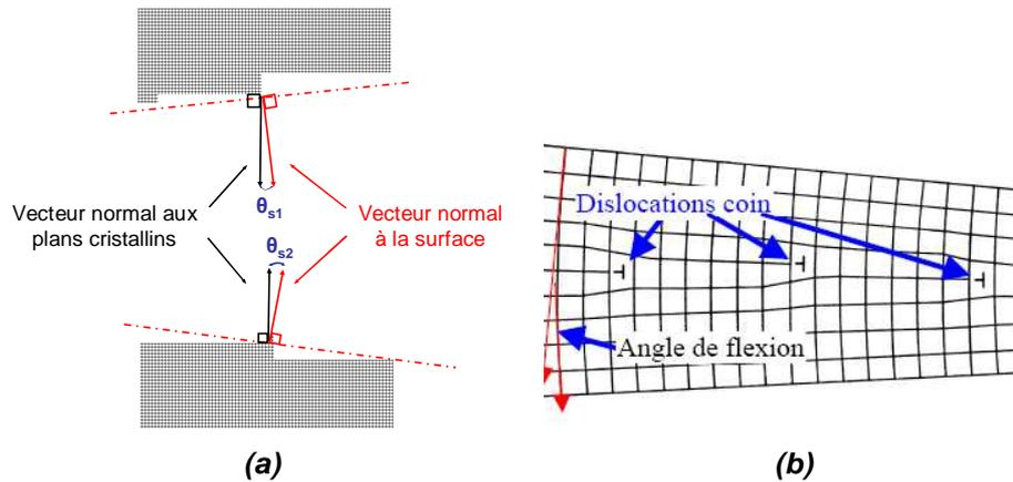
**Figure A7 : (a) Définition des angles de vicinalité ( $\theta_{s1}$  et  $\theta_{s2}$ ) de deux surfaces avant leur mise en contact. (b) Formation du réseau 1D de dislocations coin (symbolisé par  $\perp$ ) pour relaxer les contraintes dues à la désorientation de flexion entre les deux cristaux. La désorientation de flexion correspond dans ce cas à l'angle entre les vecteurs normaux aux plans cristallins à l'interface de collage.**
