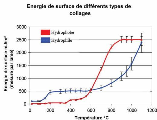
**Figure II-4 : Evolution de l'énergie de surface en fonction de la température de stabilisation pour un collage hydrophile (oxyde provenant d'une attaque chimique sur un oxyde thermique) et hydrophobe dans le cas d'une jonction de deux plaques de silicium de 100 mm de diamètre et de 520 µm d'épaisseur (courbes extraites de travaux internes au laboratoire qui peuvent également être trouvées dans la littérature [II-12]).**
