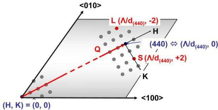
Figure IV-12 : Schéma de l'espace réciproque (dans le plan  $Q_z = 0$ ) indexé avec les indices de Miller du réseau de dislocations (H,K). Un exemple est montré pour le nœud (440) du référentiel moyen et avec un réseau de dislocations de périodicité  $\Lambda$ .
