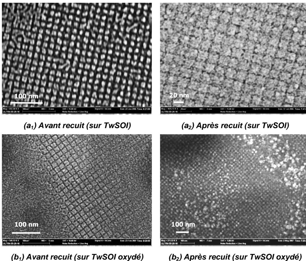
**Figure V-16 : Observations MEB de l'organisation latérale des îlots de Nickel sur (a<sub>1</sub>) substrat TwSOI et sur (b<sub>1</sub>) TwSOI oxydé avant recuit et les mêmes échantillons mais après un recuit de 1h à 500 °C (a<sub>2</sub>) et de 15 min à 500 °C (b<sub>2</sub>) respectivement.**
