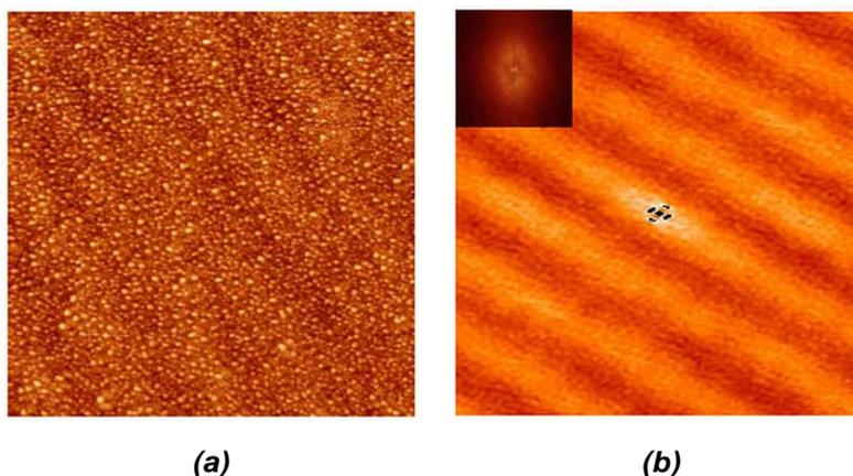
**Figure I-27 : (a) Observation STM ( $800 \times 800 \text{ nm}^2$ ) de la surface après un recuit de 10 min à 450 °C d'un dépôt de Ge à 350 °C. (b) Auto-correlation de (a) avec en insert la transformée de Fourier indiquant une symétrie d'ordre 4 [I-78].**
