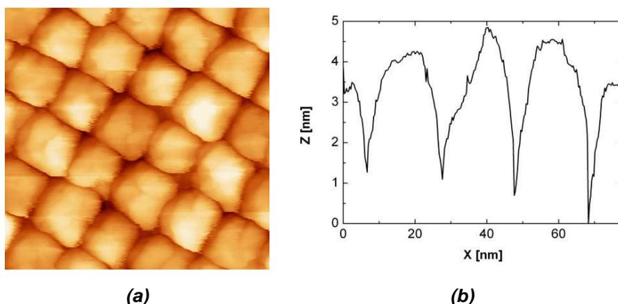
**Figure III-9 : (a) Observation STM ( $100 \times 100 \text{ nm}^2$ ) de la surface nano-structurée ( $\Lambda = 20 \text{ nm}$ ) obtenue après la double attaque (Y7+Dash) et (b) le profil obtenu à partir de l'observation (a).**
