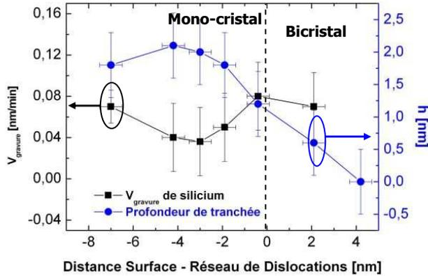
**Figure III-23 : (a) Evolution de la profondeur de tranchée et de la vitesse de gravure en fonction de la distance « Surface – Réseau de dislocations » au cours de la gravure chimique MD2 sur un échantillon TwSOI ( $\Lambda = 20$  nm) de surface plane aminci préalablement par une gravure chimique SC1 amenant la surface à + 4 nm au dessus du joint de grain.**
