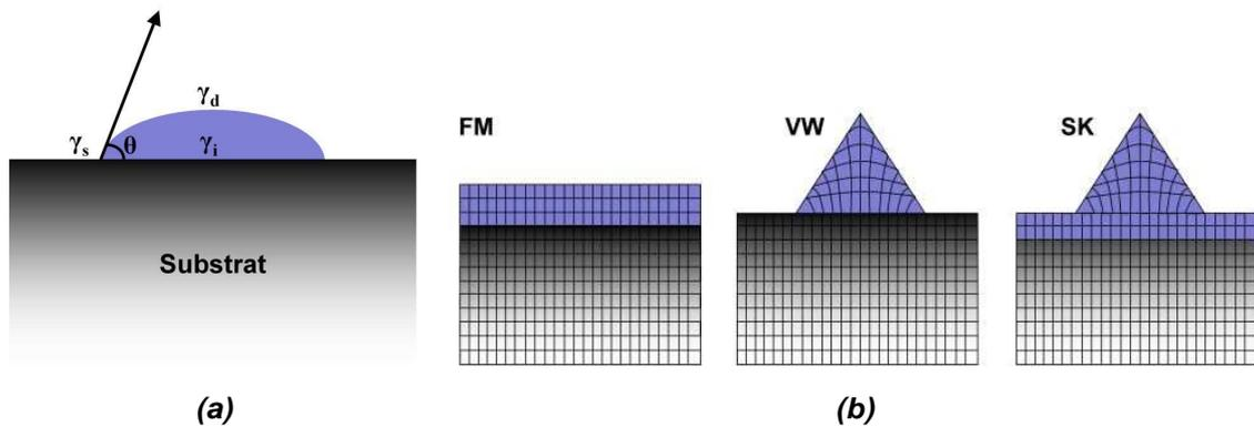
**Figure I-1 : (a) Îlot déposé sur un substrat plan avec  $\gamma_d$ ,  $\gamma_i$ , et  $\gamma_s$  respectivement les énergies de surface du matériau épitaxié, du substrat et d'interface. (b) Les trois types de mode de croissance hétéroépitaxiale : Franck-Van der Merwe (FM), Volmer-Weber (VW) et Stranski-Krastanow (SK).**
