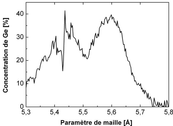
**Figure IV-18 : Estimation de la concentration de Ge à partir des valeurs du ratio des intensités diffractées pour les deux énergies ( $E_1 = 11.050$  keV et  $E_2 = 11.103$  keV) au dessous du seuil d'absorption du Ge pour la réflexion (440).**
