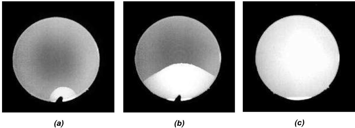
**Figure II-3 : Observations d'une onde de collage sous un microscope infrarouge (autour de  $1.3 \mu\text{m}$ ) pendant le collage de deux plaquettes de silicium de 100 mm de diamètre. (a) Après avoir posé les deux substrats l'un sur l'autre, le contact entre les deux surfaces est initié en périphérie par une légère pression locale. (b) Propagation de l'onde de collage. (c) Fin de la propagation, les deux surfaces sont collées.**
