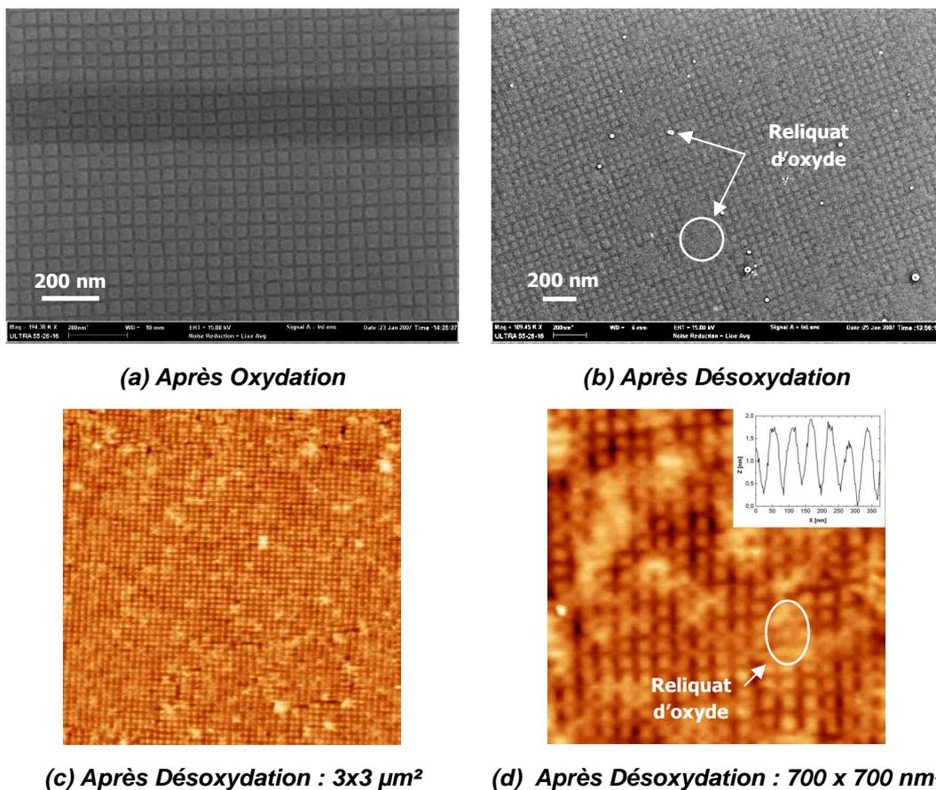
**Figure III-55 : Observations MEB avant (a) et après (b) désoxydation par  $\text{HF}_{1\%}$ . (c-d) Observations AFM après désoxydation. La surface est à environ 55 nm au dessus de l'oxyde enterré. Les cercles blancs indiquent des zones où la désoxydation ne s'est pas achevée complètement.**
