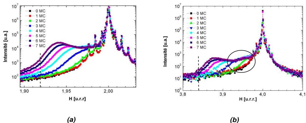
**Figure IV-25 : Balayages radiaux au voisinage de la réflexion (a) (220) et (b) (440) du silicium pour chaque monocouche de Ge déposée sur une surface nanostructurée  $\Lambda = 50$  nm. Energie = 10 keV, angle d'incidence et d'émergence :  $\alpha_i = \alpha_f = 0.166^\circ$ . Les droites verticales en pointillé indiquent les valeurs de H pour le Ge complètement relaxé au voisinage des pics de réflexion (220) et (440) du Si soit respectivement  $H \approx 1.92$  et  $H \approx 3.84$ .**
