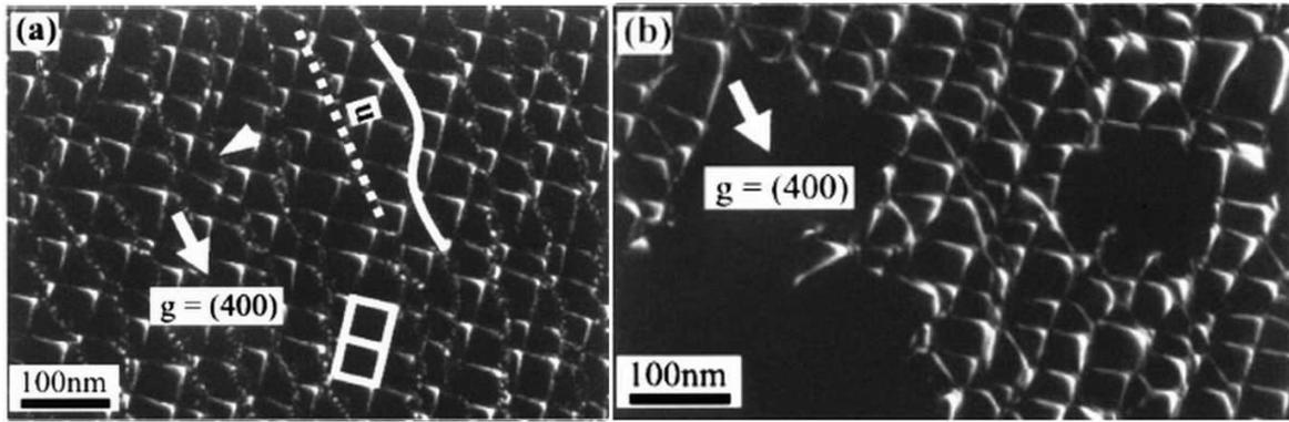
**Figure I-25 :** Images MET (vue plane) en champ sombre du réseau de dislocations après un amincissement thermique pour (a)  $t/\Lambda = 2$  et (b)  $t/\Lambda = 0.7$ . Les régions noires indiquent le mouvement local du joint de grain [I-77].
