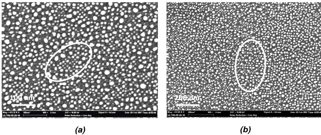
**Figure V-8 :** Observations MEB de la surface nanostructurée ( $\Lambda = 20$  nm) après une croissance de 2 nm d'argent. (a) Ordre à courte distance des plus petits îlots formant un réseau carré de périodicité  $\Lambda/\sqrt{2}$  ; (b) Ordre à courte distance d'îlots d'argent de taille légèrement plus grande de périodicité  $\Lambda$ . Ces deux configurations sont entourées par des cercles blancs où l'on peut également encore apercevoir la structuration de surface entre les îlots.
