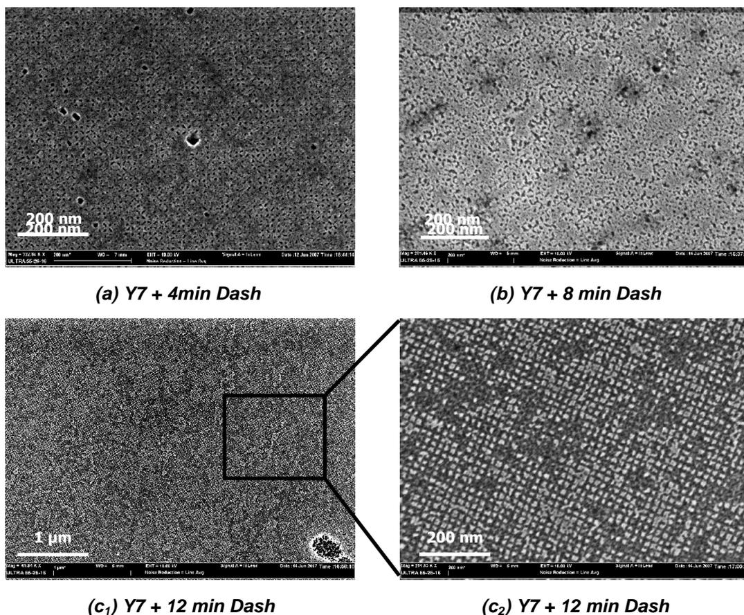
**Figure III-39 : Révélation homogène du réseau de dislocations enterrées ( $\Lambda = 20$  nm) issu d'un recuit thermique à 900 °C. Observations MEB de la surface après (a) une double gravure chimique préférentielle (Y7 (+5 nm) + 4 min Dash), suivie de (b) 4 min et de (c<sub>1</sub>-c<sub>2</sub>) 8 min supplémentaires d'une attaque Dash.**
