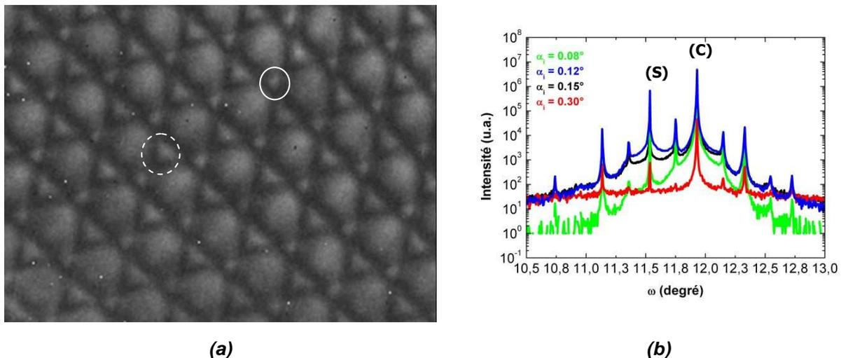
**Figure 1 : (a) Observations MET en vue plane en axe de zone [111] d'un échantillon issu d'un collage de surface « jumelles » de Si (111) avec un angle de désorientation de  $0.4^\circ$  : Le cercle en pointillé et en trait plein montre des fautes d'empilement extrinsèques et intrinsèques respectivement. (b) Spectre GIXRD pour différents angles d'incidence permettant l'indexation des pics de Bragg.**
