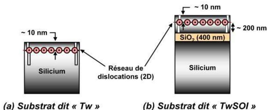
**Figure II-19 : Représentation schématique des substrats Tw et TwSOI possédant un joint de grain de torsion quasi-pure constitué d'un réseau de dislocations vis bidimensionnel de périodicité contrôlée par la méthode des échelles graduées.**
