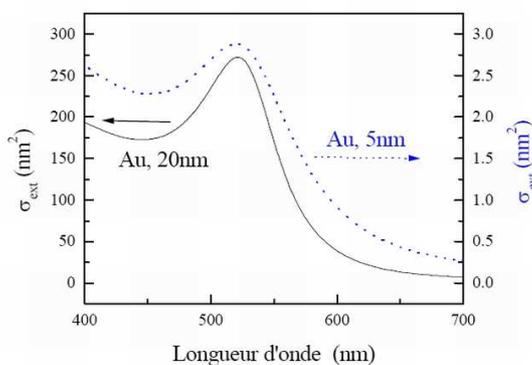
**Figure V-28 : Section efficace d'extinction calculée pour une nanoparticule d'or déposée sur une surface, de diamètre  $D = 20 \text{ nm}$  (trait continu) et  $D = 5 \text{ nm}$  (trait pointillé) [V-47].**
