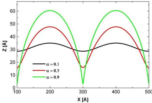
**Figure IV-5 : Morphologie de la surface modélisée par une cycloïde avec  $R=200/2\pi$  (périodicité  $\Lambda = 20$  nm) et pour différentes valeurs de  $\alpha$ . Il est important de noter la forte dilataion de l'axe Z.**
