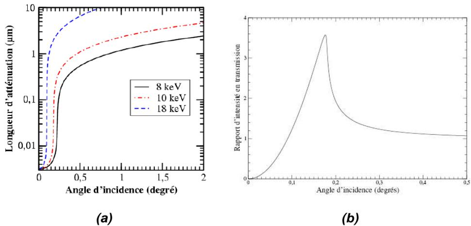
**Figure B3 : (a) Longueur d'atténuation des rayons X en fonction de l'angle d'incidence pour différentes énergies et (b) Rapport de transmission en intensité  $T$  en fonction de l'angle d'incidence pour une énergie de 10 keV. Le maximum correspond à l'angle critique.**
