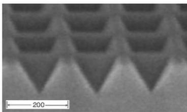
**Figure I-11 : Observation MEB d'un réseau carré de pyramides inversées dans une matrice de Si (001). Un oxyde chimique est ensuite créé pour empêcher les réactions entre le Si et les futurs métaux déposés. La barre d'échelle est 200 nm [I-45].**
