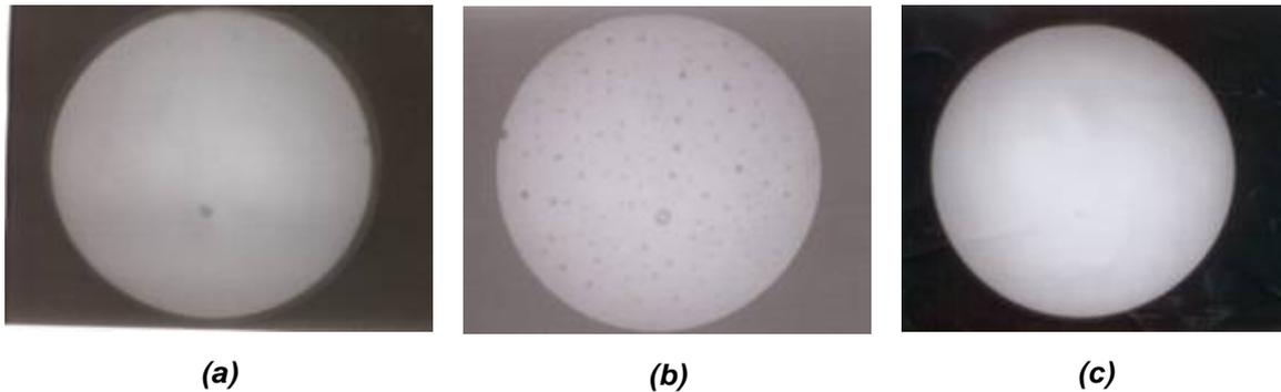
**Figure II-5 : Observations sous microscope infrarouge de l'interface d'un collage hydrophobe après (a) le collage à température ambiante, (b) un recuit à 500 °C pendant 1h et (c) un recuit à 900 °C pendant 1h.**
