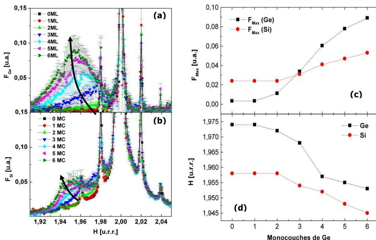
**Figure IV-21 : Facteurs de structure du (a) Ge et du (b) Si extraits des mesures GIXRD pour 9 énergies de part et d'autre du seuil d'absorption du Ge. (c) Evolution de la valeur maximale du facteur de structure du Si et du Ge en fonction du nombre de monocouches déposées de Ge. (d) Evolution de la position du maximum du facteur de structure (indexé par l'indice de Miller H) en fonction du nombre de monocouches déposées de Ge.**
