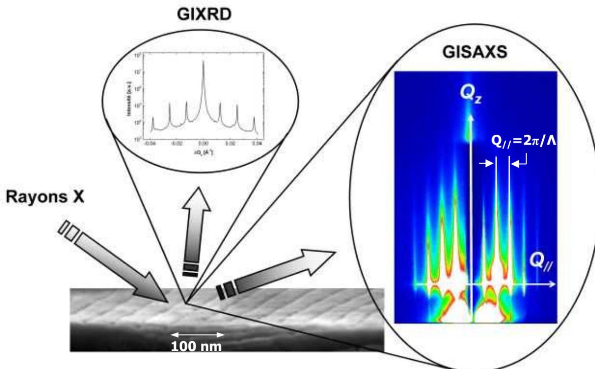
**Figure IV-23 :** Cliché GIXRD et GISAXS suivant l'azimut  $\langle 110 \rangle$  d'un échantillon TwSOI nanostructuré ( $\Lambda = 50$  nm) avant croissance de Ge.  $E = 10$  keV et angles d'incidence et d'émergence :  $\alpha_i = \alpha_f = 0.166^\circ$
