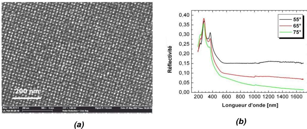
**Figure V-25 : (a) Observation MEB de la surface d'un échantillon nanostructuré Tw (sans couche d'oxyde enterré) de périodicité  $\Lambda = 20$  nm avec une épaisseur équivalente de 3.5 nm d'or déposée et (b) le spectre de réflectivité mesuré sur cet échantillon pour différents angles d'incidence en polarisation P.**
