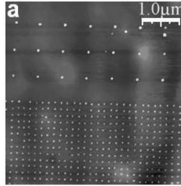
**Figure I-8 :** Image AFM d'un réseau d'îlots de Ge de différentes périodes obtenu à partir d'une structuration de surface réalisée par faisceau d'ions Ga<sup>+</sup> (FIB) [I-35].
