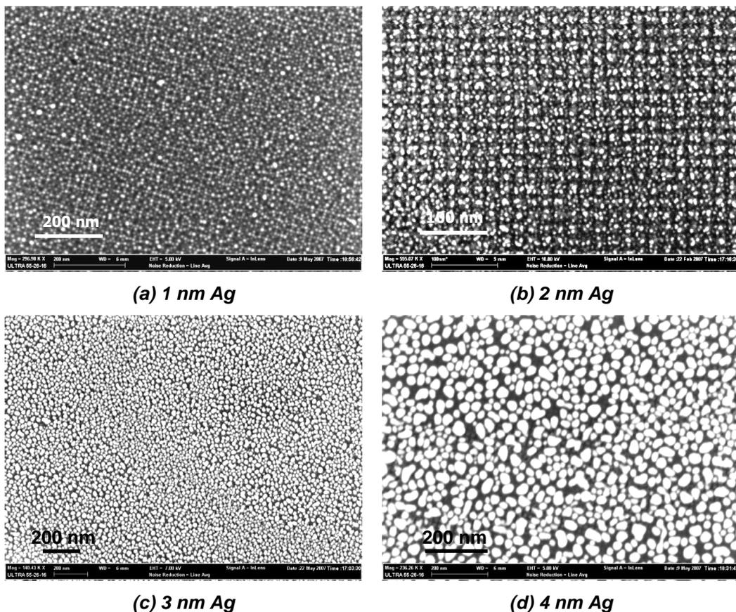
**Figure V-11 : Observations MEB de la surface nanostructurée ( $\Lambda = 20 \text{ nm}$ ) après une croissance de (a) 1 nm, (b) 2 nm, (c) 3 nm et (d) 4 nm d'argent à  $v_{\text{dépôt}} = 0.1 \text{ nm/s}$ .**
