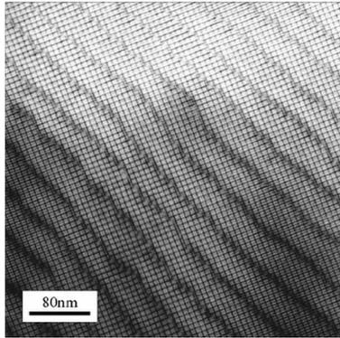
**Figure I-19 :** Observation MET en vue plane d'un joint de grain obtenu par un collage moléculaire standard Si(001)/Si(001). L'angle de rotation est approximativement contrôlé par les méplats des deux plaques de Si. Un réseau 2D de dislocations vis perturbé par un réseau 1D de dislocations mixtes est obtenu avec un angle de torsion de  $2.75^\circ \pm 0.1^\circ$  et un angle de flexion de  $0.34^\circ \pm 0.03^\circ$  respectivement [I-76].
