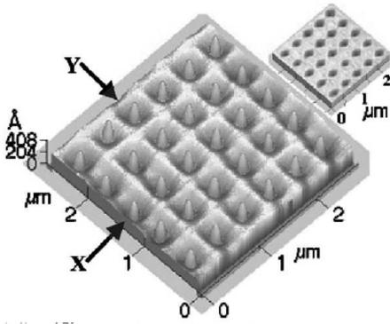
**Figure I-7 :** Image AFM (Atomic Force Microscopy) de la surface structurée après une lithographie holographique et après une croissance de six monocouches de Ge à 700°C. Au centre de chaque motif, un îlot de Ge. En insert est montrée la structuration de surface avant croissance obtenue par lithographie holographique. Périodicité : 500 nm et une profondeur de 50 nm [I-34].
