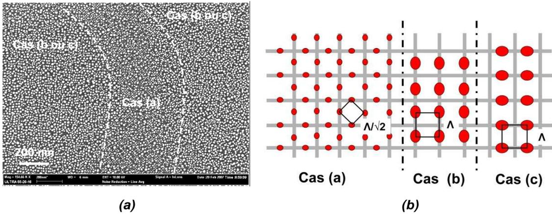
**Figure V-7 :** (a) Observation MEB de la croissance d'une épaisseur équivalente de 2 nm d'argent sur une surface nanostructurée ( $\Lambda = 20$  nm) ; (b) Représentation schématique du positionnement des îlots d'argent (plots rouges) selon leur taille, en fonction de la morphologie de surface (les lignes grises correspondent aux lignes de dislocations gravées, i.e. les tranchées).
