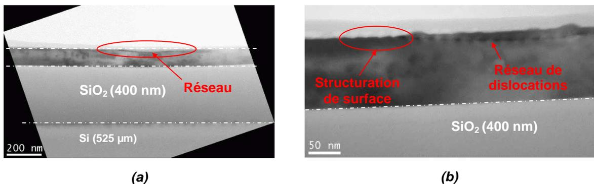
**Figure III-36 : Observations MET en vue transverse d'un échantillon TwSOI de périodicité 20 nm après attaque chimique préférentielle Y7. (a) Le cercle rouge indique une zone où le réseau de dislocations est encore sous la surface mais dont les extrémités sont déjà gravées. (b) Zone structurée (indiquée par un cercle rouge) avec disparition locale du réseau de dislocations. [V. Poydenot].**
