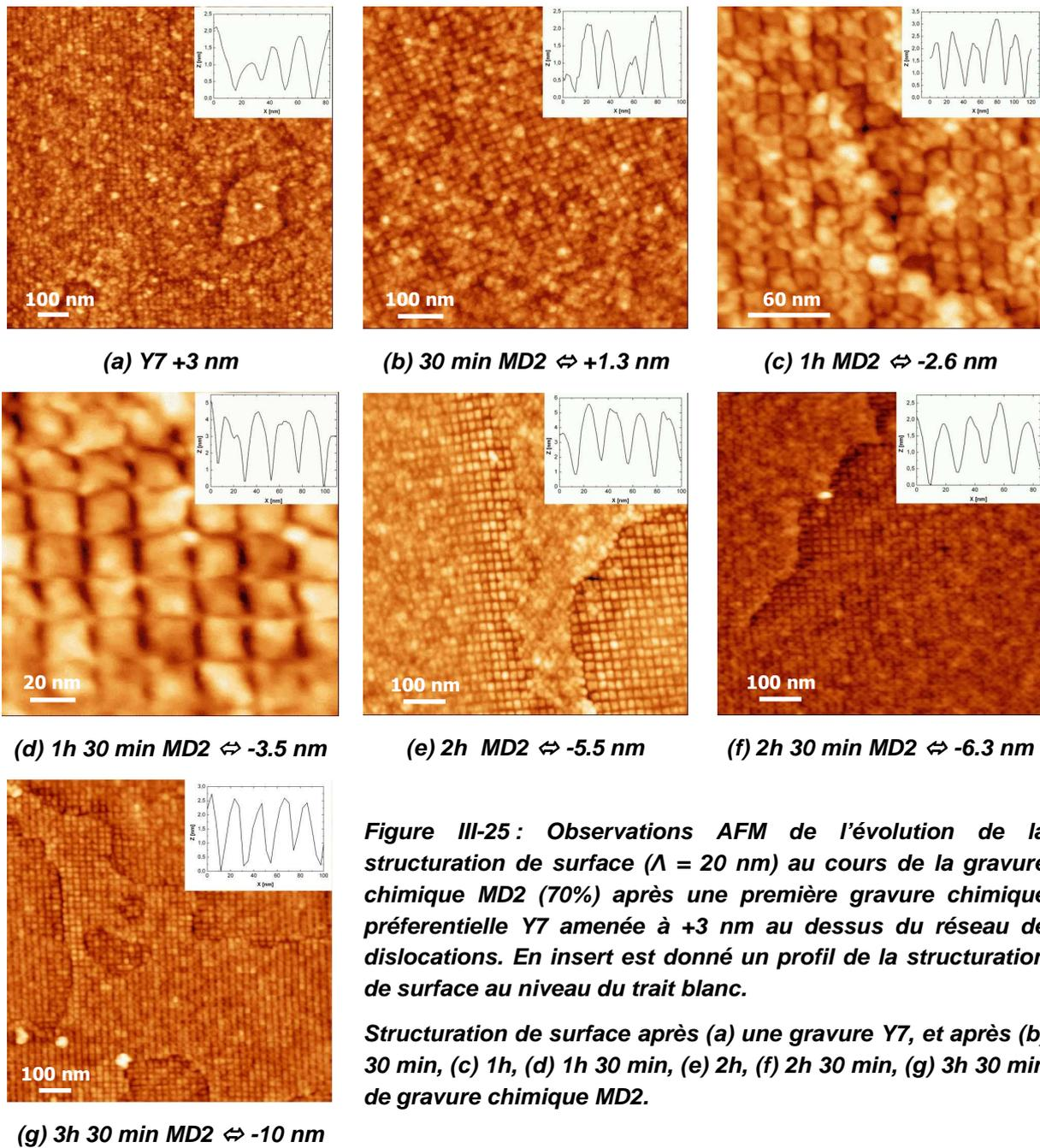
**Figure III-25 :** Observations AFM de l'évolution de la structuration de surface ( $\Lambda = 20$  nm) au cours de la gravure chimique MD2 (70%) après une première gravure chimique préférentielle Y7 amenée à +3 nm au dessus du réseau de dislocations. En insert est donné un profil de la structuration de surface au niveau du trait blanc.
