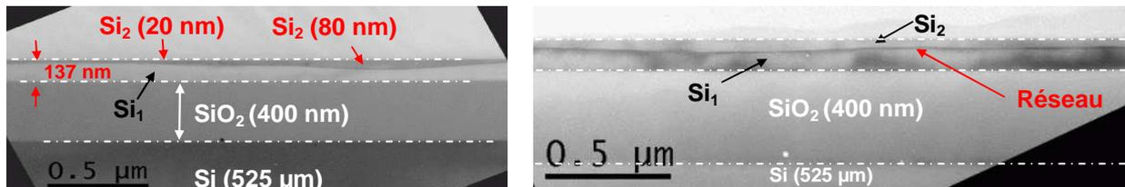
**Figure III-35 : Images MET en vue transverse d'un échantillon TwSOI de périodicité 20 nm aminci par une gravure chimique SC1 amenant la surface à environ +34 nm de l'interface de collage. L'interface de collage entre les deux cristaux de silicium apparaît avec une certaine fluctuation verticale [V. Poydenot].**
