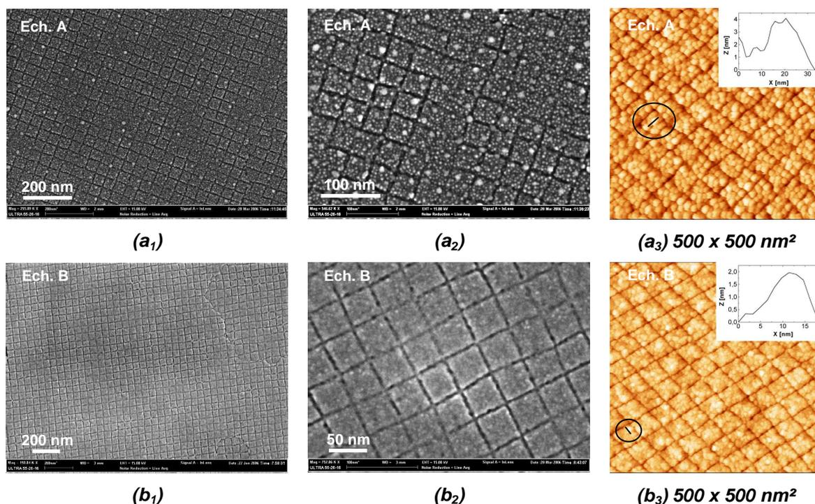
**Figure IV-1 : Observations MEB ( $a_{1,2}$  et  $b_{1,2}$ ) et STM ( $a_3$  et  $b_3$ ) de la surface nanostructurée après croissance de 1 nm de Ge : avec une rampe de descente en température (jusqu'à l'ambiante) lente ( $a_1 - a_3$ ) et rapide ( $b_1 - b_3$ ). Les inserts montrent les profils des îlots de Ge sur un mesa de silicium indiqué par le trait noir entouré par un cercle noir.**
