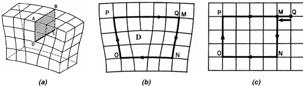
**Figure A2:** (a) Représentation de la dislocation coin. (b) Circuit de Burgers autour d'une dislocation coin. (c) Le même circuit dans un cristal parfait. Le vecteur QM nécessaire à la fermeture du circuit de Burgers de la dislocation de la figure (a) définit le vecteur de Burgers.
