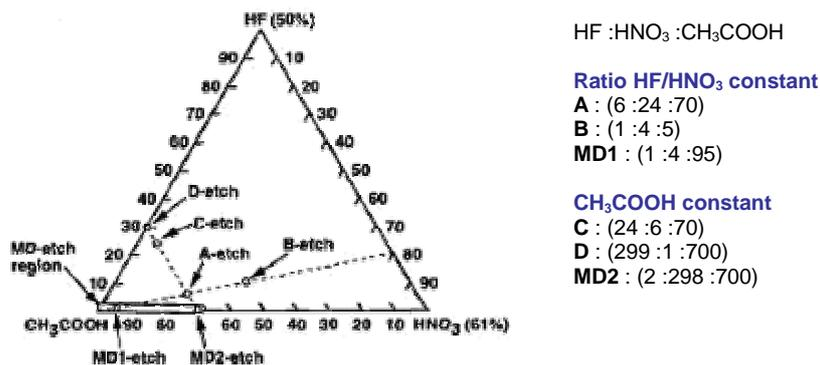
**Figure III-12 : Diagramme ternaire des constituants dans le système HNA. Les différentes solutions testées par Kashiwagi et al sont indiquées sur le diagramme. Les solutions A, B et MD1 ont le même ratio HF/HNO<sub>3</sub>, seule la concentration en acide acétique change, et réciproquement, les solutions C, D et MD2 sont à volume d'acide acétique constant et seul le ratio HF/HNO<sub>3</sub> change [III-24].**
