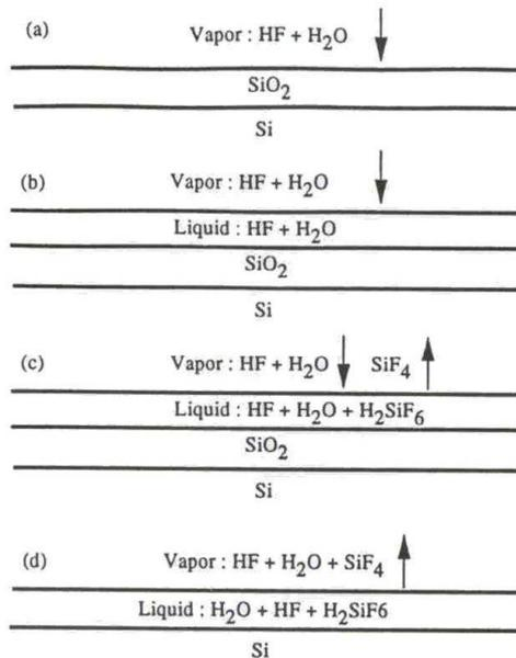
Figure II-14 : Mécanismes de réactions d'une vapeur de HF/H<sub>2</sub>O sur un oxyde de silicium [II-26].
