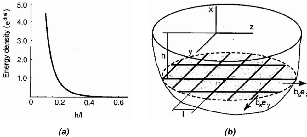
**Figure III-38 : (a) Evolution de la densité d'énergie élastique (en unité de  $G\psi^2$  avec  $G$  le module de cisaillement et  $\psi$  l'angle de désorientation) en fonction de la distance normalisée  $h/l$  où  $h$  est l'épaisseur de film au dessus du réseau de dislocations et  $l$  la périodicité du réseau de dislocations comme illustré en (b) [III-34].**
