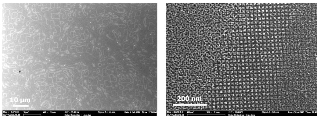
**Figure III-33 :Observations MEB de la structuration de surface d'un échantillon Tw de périodicité  $\Lambda = 20 \text{ nm}$  obtenue après une double gravure Y7 + 1h MD2(70%) pour deux tailles de balayages.**
