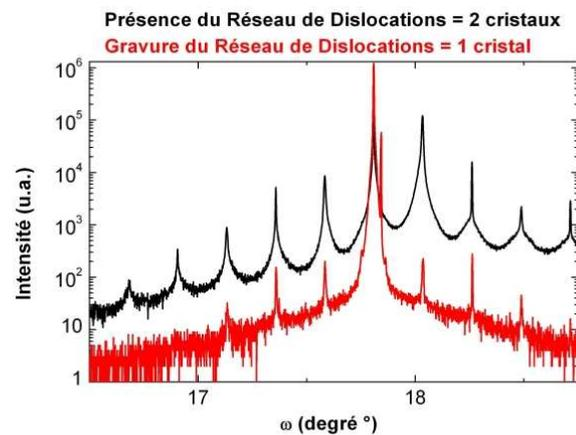
**Figure III-45 :** Balayages angulaires  $\omega$ -scan autour de la raie (220) sur un même échantillon avec deux niveaux de gravure différents : pour la courbe noire, la gravure s'est arrêtée avant d'atteindre le réseau de dislocations (environ +5 nm) et pour la courbe rouge, la gravure s'est arrêtée au-delà du réseau de dislocations (environ -5 nm).  $\alpha_i = \alpha_f = 0,24^\circ$  et  $E = 10$  keV.
