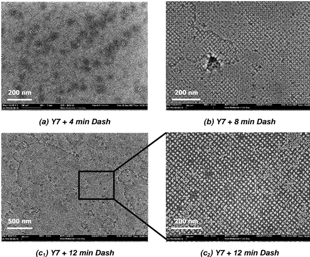
Figure III-41 : Révélation homogène du réseau de dislocations enterrées ( $\Lambda = 20$  nm) issu d'un recuit thermique à 1100 °C. Observations MEB de la surface après (a) une double gravure chimique préférentielle (Y7 (+5 nm) + 4 min Dash), suivie de (b) 4 min et de (c<sub>1</sub>-c<sub>2</sub>) 8 min supplémentaires d'une attaque Dash.
