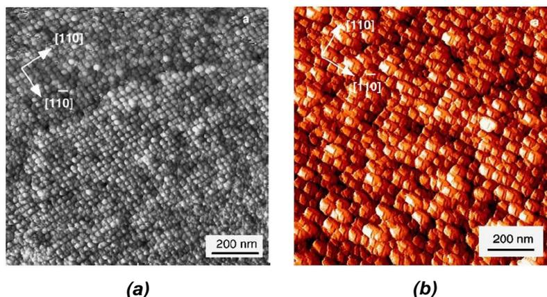
**Figure I-28 :** (a) Image STM ( $1120 \times 1120 \text{ nm}^2$ ) de la surface nanostructurée ( $\Lambda = 25 \text{ nm}$ ). La profondeur de tranchées est de l'ordre de  $5 \text{ nm}$ . (b) Image STM ( $560 \times 560 \text{ nm}^2$ ) de la surface après un dépôt de  $0.9 \text{ nm}$  de Ge à  $490 \text{ °C}$ . L'organisation latérale des îlots de Ge est observée [I-82].
