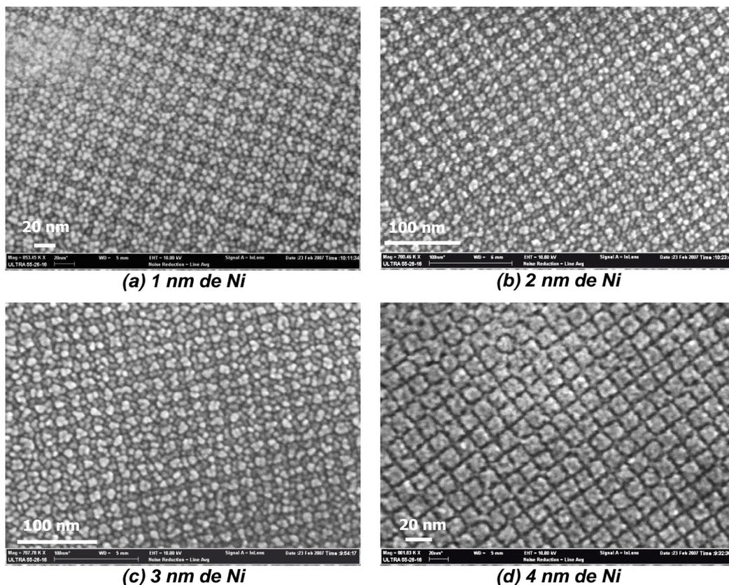
**Figure V-13 : Observations MEB des croissances de (a) 1 nm, (b) 2 nm, (c) 3 nm, et (d) 4 nm de nickel à température ambiante et à  $v_{\text{dépôt}} = 0.01 \text{ nm/s}$  sur des échantillons TwSOI nanostructurés ( $\Lambda = 20 \text{ nm}$ ) oxydés.**
