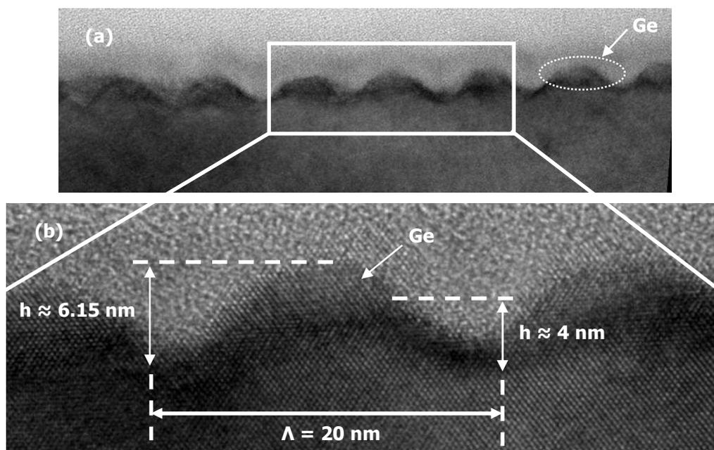
**Figure IV-4 : Observations MET d'une surface nanostructurée ( $\lambda = 20$  nm) par une double gravure chimique préférentielle (Y7+MD2) après une croissance de 6 monocouches de Ge à faible grandissement (a) et en mode Haute Résolution (b). [D. Lafond, K. Rousseau].**
