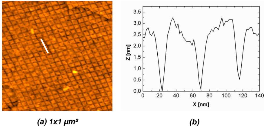
**Figure III-49 : (a) Observation AFM de la surface nanostructurée ( $\Lambda = 50 \text{ nm}$ ) obtenue après une double gravure chimique préférentielle (Y7+MD2). (b) Profil AFM de la structuration de surface au niveau du trait blanc (a) donnant une profondeur de tranchée  $h \approx 3 \text{ nm}$ .**
