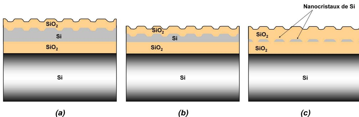
**Figure III-56 : Représentation schématique de l'évolution de l'amincissement thermique (a-b) d'un film de Si nanostructuré issu d'un échantillon TwSOI pour l'obtention (c) de nanocristaux de Si sur oxyde de silicium.**
