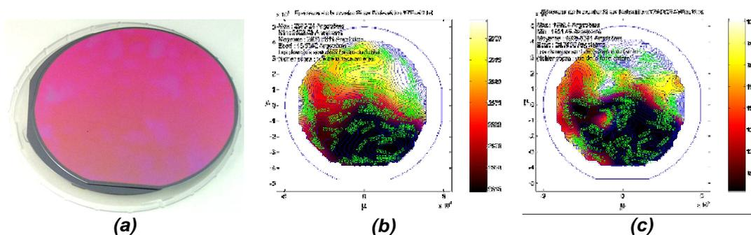
**Figure III-1 : (a) Plaque SOI de diamètre 100 mm après une gravure chimique Y7 de 30 min (près de 90 nm gravée) ; cartographies de l'épaisseur de silicium par ellipsométrie avant (a) et après attaque Y7 (b).**
