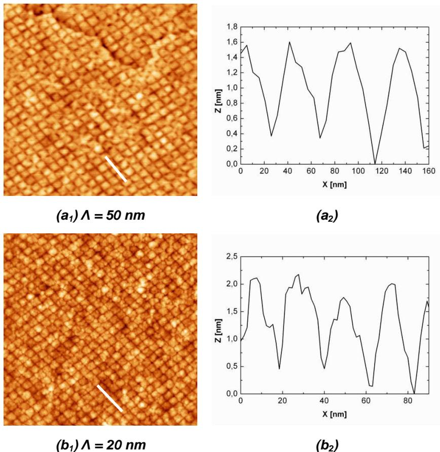
**Figure III-7 :** (a<sub>1</sub>) Image AFM et (b<sub>1</sub>) STM de la structuration de surface après une attaque chimique préférentielle Y7 pour un réseau de dislocations de périodicité (a<sub>1</sub>)  $\Lambda = 50$  nm et (b<sub>1</sub>)  $\Lambda = 20$  nm avec (a<sub>2</sub>) et (b<sub>2</sub>) leurs profils respectifs mesurés au niveau des traits blancs sur les images AFM (a<sub>1</sub>) et STM (b<sub>1</sub>).
