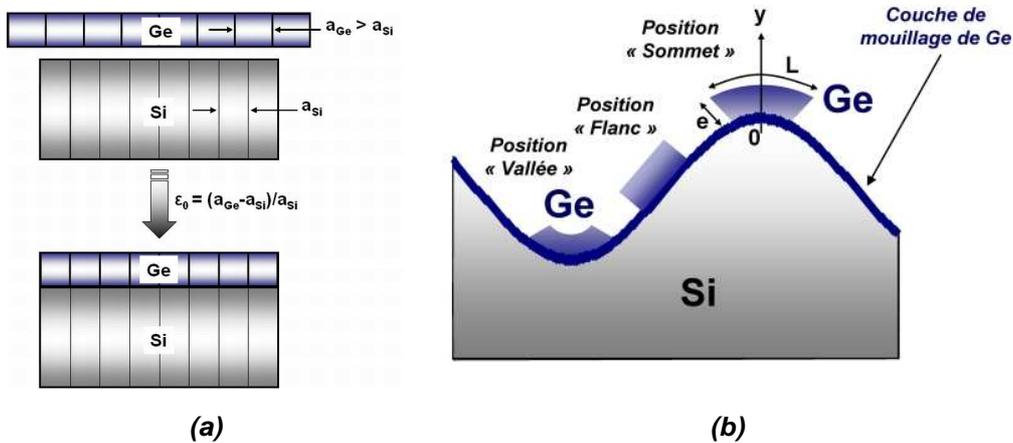
**Figure IV-6 : Schéma de la contrainte élastique biaxiale d'une pastille de Ge plate (a) et (b) courbée. Les différentes positions envisageables de l'îlot de Ge sont indiquées. Les courbures sont exagérées pour montrer les phénomènes.**
