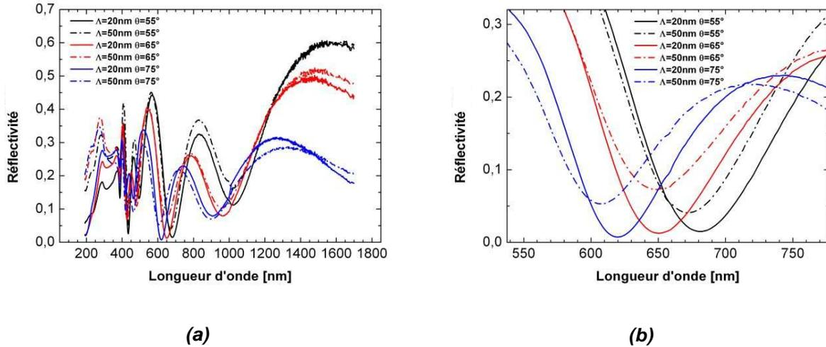
**Figure V-24 : (a) Spectres de réflectivité pour différents angles d'incidence sur deux échantillons TwSOI de périodicité 20 et 50 nm (traits pleins et pointillés respectivement) sur lesquels une épaisseur équivalente de 4 nm a été déposée. (b) Un agrandissement de la région supposée correspondre à une absorption d'origine plasmonique au voisinage de 650 nm.**
