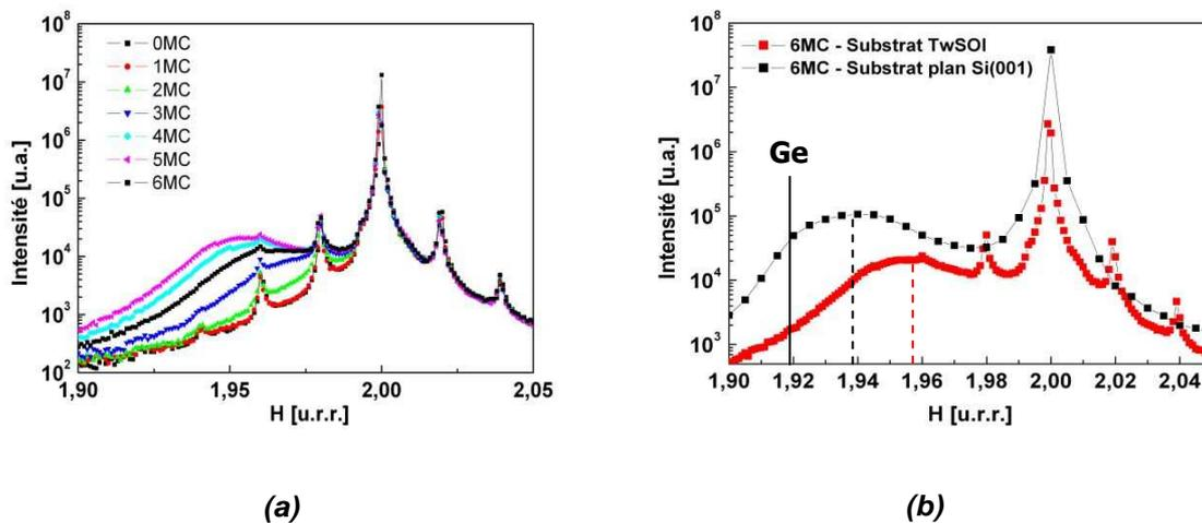
**Figure IV-20 : (a) Balayages radiaux en incidence rasante autour de la raie (220) du silicium pour chaque monocouche de Ge déposée à 500 °C sur un substrat TwSOI nanostructuré ( $\lambda = 20$  nm). (b) Comparaison de l'intensité diffractée issue d'une croissance de 6 monocouches de Ge à 500°C sur un substrat TwSOI nanostructuré ( $\lambda = 20$  nm) et sur un substrat de Si (001) plan. Energie = 11 keV. Angles d'incidence et d'émergence :  $\alpha_i = \alpha_f = 0.166$  °**
