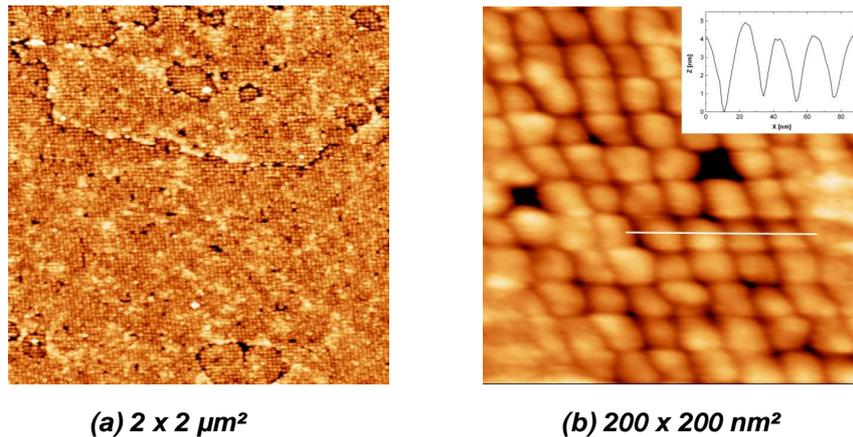
**Figure III-42 : Observations AFM d'une surface nanostructurée ( $\Lambda = 20$  nm) obtenue par révélation d'un réseau de dislocations issu d'un recuit thermique à 1100 °C suite à une double gravure chimique préférentielle (Y7+Dash).**
