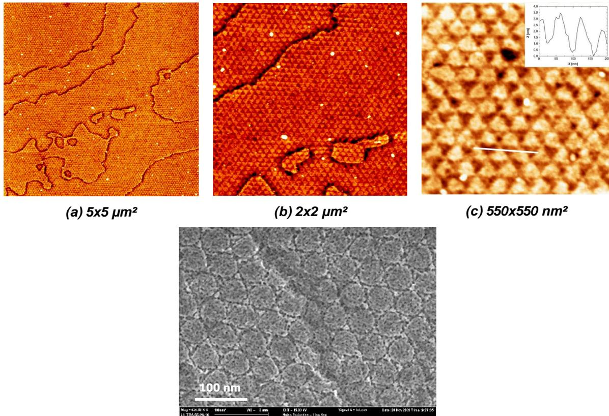
**Figure 2 : Observations AFM (a-c) et MEB (d) de la surface après une double gravure chimique préférentielle (Y7+Dash) sur un échantillon issu d'un collage de surfaces « jumelles » de Si/Si(111) avec un angle de désorientation de  $0.4^\circ$ .**
