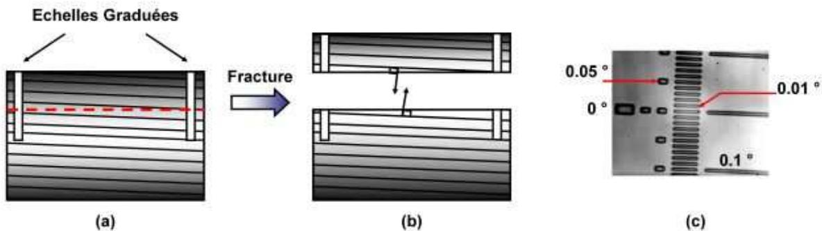
**Figure I-21 :** Représentation schématique de la fabrication des surfaces jumelles avec le système de repérage pour le contrôle d'angle en rotation. Avant (a) et après (b) la fracture et (c) image de l'échelle graduée obtenue après l'étape de photolithographie.
