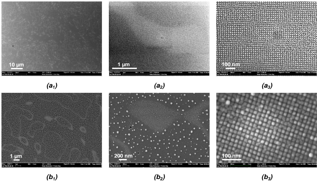
**Figure IV-2 : Observations MEB pour différentes échelles d'une structuration de surface ( $\Lambda = 20$  nm) après (a<sub>1</sub> – a<sub>3</sub>) une double gravure chimique préférentielle et après (b<sub>1</sub> – b<sub>3</sub>) une croissance d'une épaisseur équivalente de 6 monocouches (environ 0.85 nm) de Ge déposées à 500 °C.**
