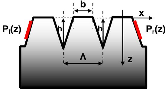
**Figure III-47 :** Représentation schématique de la structuration de surface utilisée pour la modélisation du signal GIXRD : trapèze symétrique ( $P_l=P_r=P$ ).  $\Lambda$  étant la périodicité de la structuration de surface,  $b$  la largeur du méso et  $h$  la profondeur de tranchée.
