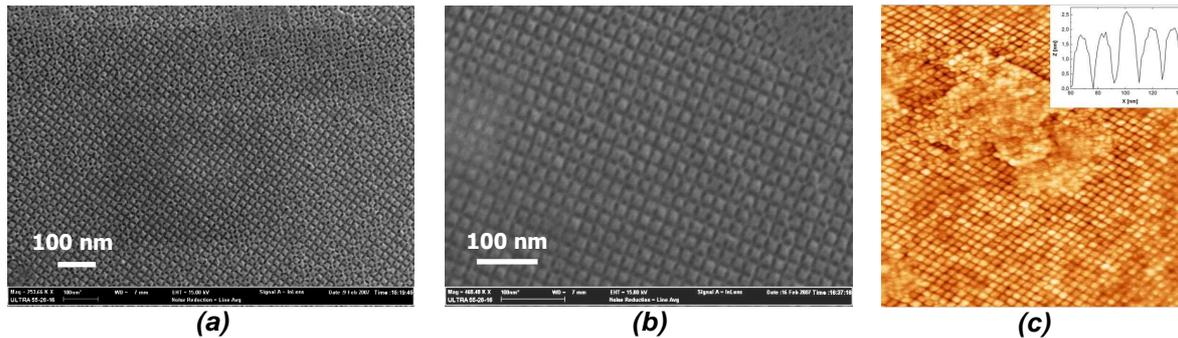
**Figure III-53 : Observations MEB de la surface nanostructurée ( $\Lambda = 20$  nm) avant (a) et après (b) l'oxydation thermique. (c) Observation AFM ( $700 \times 700$  nm<sup>2</sup>) de la surface nanostructurée oxydée. En insert est indiqué un profil de la structuration de surface.**
