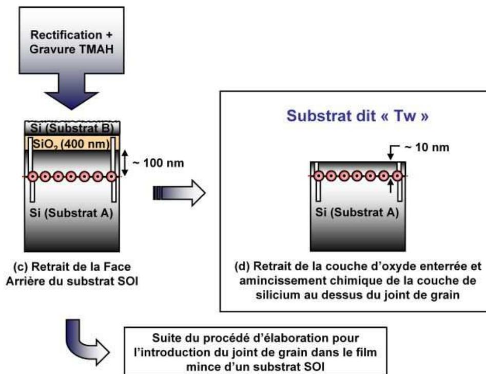
**Figure II-16 :** (c) Retrait de la face arrière du SOI (substrat B) par rectification suivie d'une gravure chimique TMAH utilisant la couche de SiO<sub>2</sub> comme couche d'arrêt. (c) Retrait de l'oxyde thermique par une gravure chimique HF libérant le substrat de silicium avec un réseau de dislocations enterrées (substrat « Tw ») ou poursuite du procédé d'élaboration pour introduire le réseau de dislocations au sein d'une structure SOI.
