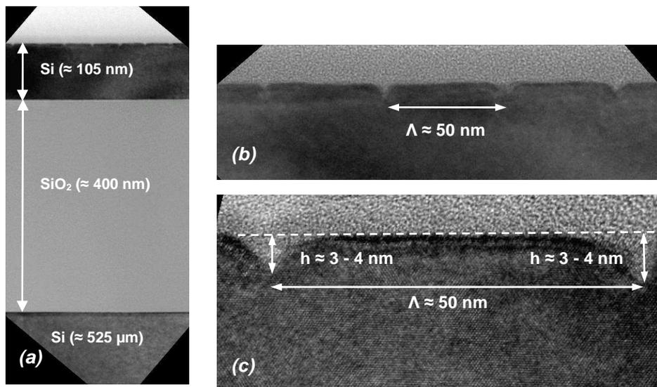
Figure III-18 : Images MET en coupe du substrat TwSOI nanostructuré ( $\Lambda = 50 \text{ nm}$ ) obtenu après une double gravure chimique préférentielle. (a) Vue en coupe d'un substrat TwSOI structuré. (b) Agrandissement au niveau de la structuration de surface, et (c) image Haute Résolution (HRTEM) sur un méssa de silicium permettant d'extraire les profondeurs de tranchées [D. Lafond, K. Rousseau (Société SERMA)].
