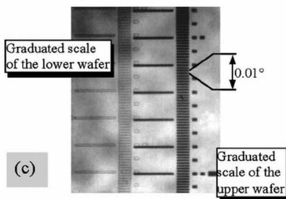
**Figure I-24 : Alignement des plaques sous le microscope infrarouge. L'échelle de la plaque du dessus fait face à l'échelle de la plaque du dessous juste avant le recollage pour obtenir l'angle de désorientation désiré [I-76].**
