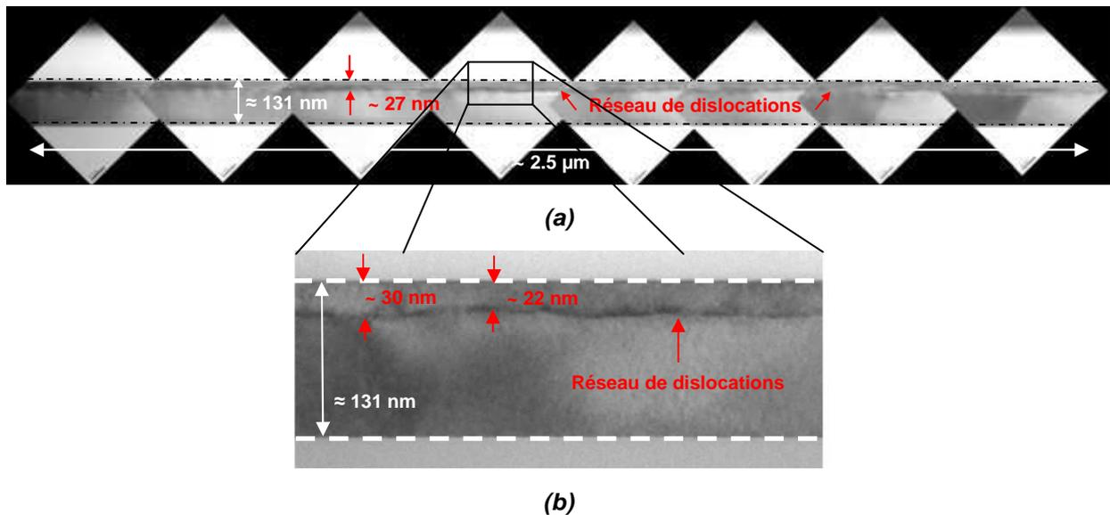
**Figure III-37 : (a) Observations MET en coupe juxtaposées pour obtenir une grande zone d'observation. Le joint de grain d'un échantillon TwSOI ( $\Lambda = 50$  nm) aminci par gravure chimique isotrope SC1 amenant la surface à environ + 27 nm est bien visible et semble plan malgré une légère fluctuation. (b) Agrandissement de l'image (a) indiquant la faible oscillation du joint de grain. [D. Lafond, K. Rousseau (Société SERMA)].**
