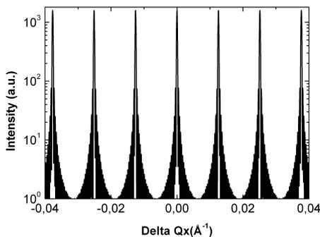
**Figure III-46 : Simulation du facteur de structure avec  $m = 40$  et  $\Lambda = 50$  nm. L'intensité est tracée en fonction de la variation du transfert de moment projeté dans la direction x (avec  $\Delta Q_x = 2\pi/\Lambda$ ).**
