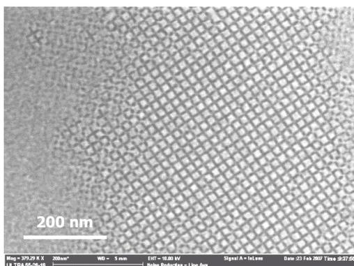
**Figure V-12 : Observation MEB d'une surface TwSOI nanostructurée oxydée thermiquement ( $\Lambda = 20$  nm) à 900 °C pendant 10 min pour former une couche d'oxyde de silicium épaisse de  $e_{SiO_2} = 10$  nm.**
