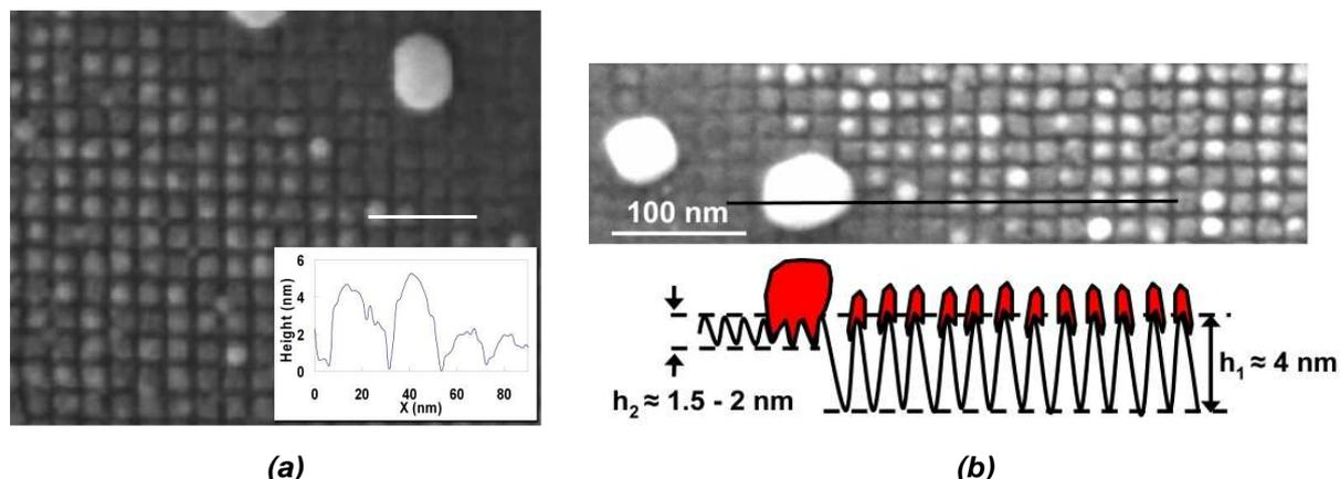
**Figure IV-3 : Observation MEB de la surface structurée ( $\lambda = 20$  nm) après les 6 monocouches de germanium déposées avec (a) en insert un profil STM de la surface et le schéma représentatif est donné en (b).**
