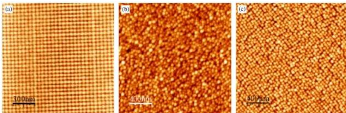
**Figure I-10 : Images AFM de : (a) la zone  $\text{SiO}_2/\text{Si}$  structurée par le faisceau d'ions  $\text{Ga}^+$ . Le diamètre des trous est de 25 nm et de périodicité 50 nm. Après un dépôt d'une épaisseur équivalente de 2 nm de Ge à température ambiante et un recuit à 600 °C pendant 30 min sur (b) une surface non structurée et sur (c) une surface structurée par le faisceau d'ions [I-43].**
