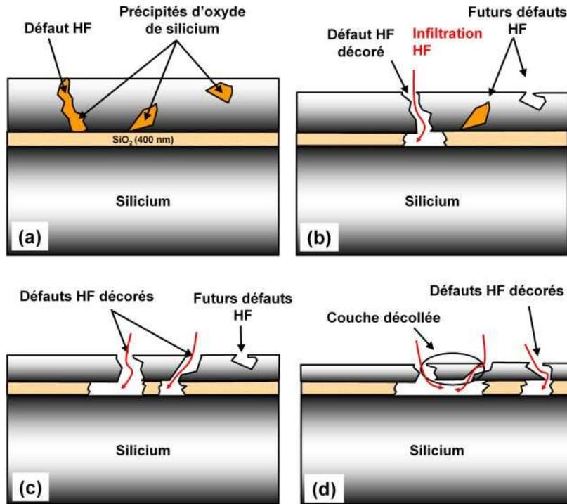
**Figure III-16 : Représentation schématique de défauts HF introduits dans le film mince d'un substrat SOI. (a) Avant attaque chimique Dash. (b-d) Au cours de la gravure chimique les défauts HF enterrés se révèlent.**
