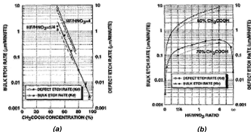
**Figure III-13 : (a) Evolution de la vitesse de gravure du silicium massif (triangles) et sur les défauts cristallins (cercles) en fonction de la concentration d'acide acétique pour deux ratios HF/HNO<sub>3</sub> donnés et (b) évolution de la vitesse de gravure du silicium massif (triangles) et sur les défauts cristallins (cercles) en fonction du ratio HF/HNO<sub>3</sub> et pour deux concentrations d'acide acétique données à 50% et à 70% [III-24].**
