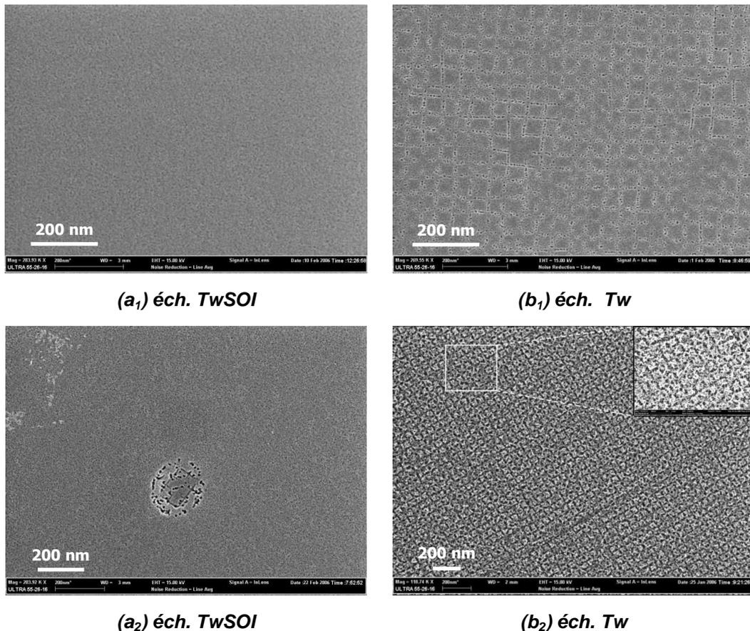
Figure III-30 : Observations MEB de la surface ( $\Lambda = 50$  nm) après 3 minutes de gravure Dash obtenue sur un échantillon TwSOI (a<sub>1</sub>) et Tw (b<sub>1</sub>) et après 6 minutes supplémentaires sur les mêmes échantillons (a<sub>2</sub>) pour l'échantillon TwSOI et (b<sub>2</sub>) pour le Tw (en insert est montrée un agrandissement de la surface).
