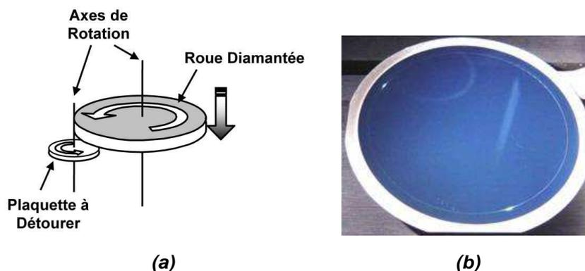
**Figure II-10 : (a) Schéma de principe du détourage. La roue diamantée et la plaque à détourer tournent en sens contraire. La roue descend graduellement abrasant la périphérie de la plaque et s'arrête à une côte donnée avec une précision de 1  $\mu\text{m}$ . (b) Photo d'un Négatif détourné avec l'échelle graduée en périphérie de la plaque.**
