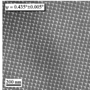
**Figure I-20 :** Observation MET en vue plane d'un joint de grain de torsion pure obtenu à partir du collage moléculaire de deux plaques de Si(001) de surfaces « jumelles » avec le contrôle des angles grâce aux échelles graduées. La valeur visée était  $0.44^\circ$  pour obtenir une période de 50 nm et la valeur mesurée au MET est de  $0.435 \pm 0.005^\circ$ . L'absence du réseau de dislocations mixte indique un angle de flexion inférieur à  $0.01^\circ$  [I-76].
