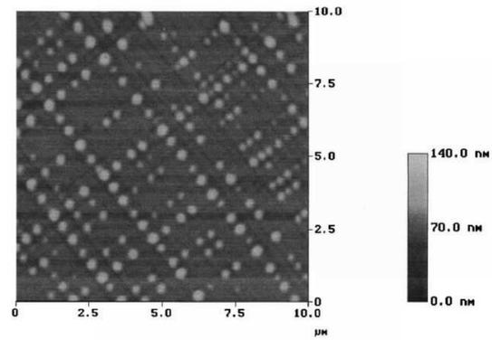
**Figure I-15 : Observation AFM de boîtes de Ge déposées sur une couche de Si contraint par une couche SiGe relaxée. Les îlots de Ge s'alignent sur les champs de déformations induits par le réseau enterré de dislocations de misfit [I-51].**
