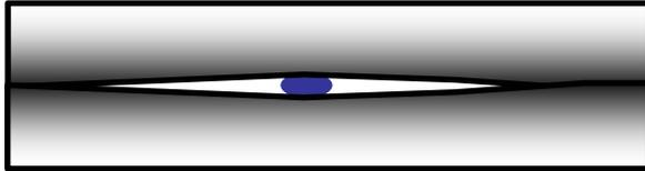
**Figure II-2 : Formation d'un défaut de collage de 2.5 mm de diamètre induit par une particule de 0,5 µm de diamètre coincée à l'interface de collage.**
