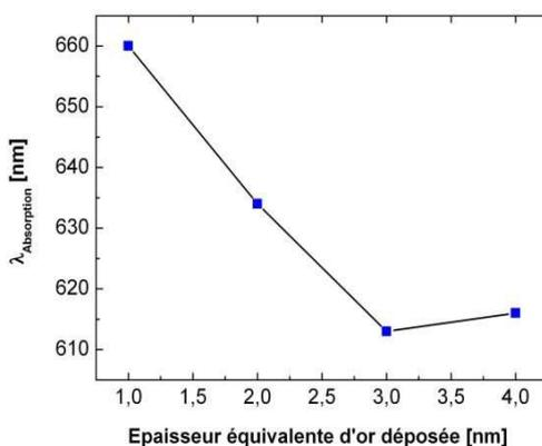
**Figure V-22 : Evolution de la longueur d'onde d'absorption en fonction de l'épaisseur équivalente déposée d'or sur des échantillons TwSOI nanostructurés ( $\Lambda = 20$  nm) pour un angle d'incidence de 75°.**
