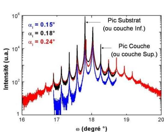
**Figure III-44 :** Balayages angulaire ( $\omega$ -scan) autour de la raie (220), pour trois incidences différentes permettant la détermination des pics de Bragg (couche supérieure ou inférieure par rapport au plan du réseau de dislocations).
