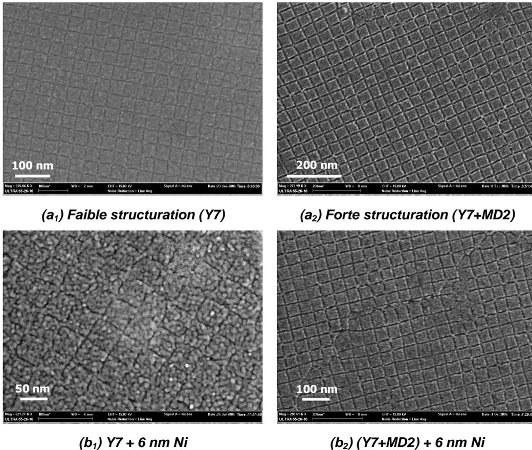
**Figure V-2 : Observations MEB d'une surface nanostructurée ( $\Lambda = 50$  nm) après (a<sub>1</sub>) une gravure Y7 et (a<sub>2</sub>) après une double gravure chimique (Y7+MD2). Croissance d'une épaisseur équivalente de 6 nm de Nickel à température ambiante sur une surface nanostructurée (b<sub>1</sub>) Y7 et sur une surface nanostructurée Y7+MD2 (b<sub>2</sub>).**
