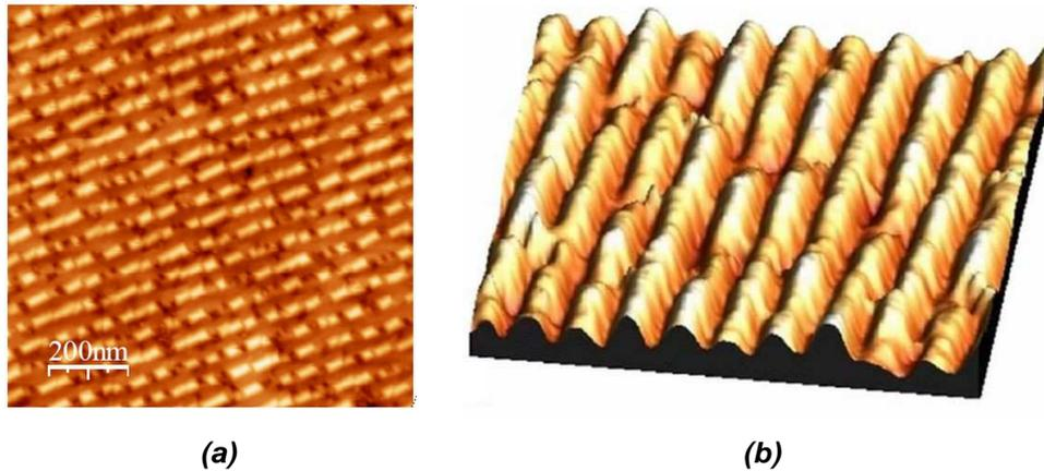
**Figure I-17 : Image AFM ( $1 \times 1 \mu\text{m}^2$ ) (a) 2D et (b) 3D [I-72] de l'organisation 1D d'îlots de Ge après un dépôt de 6 monocouches de Ge à 550 °C. Périodicité 44 nm (angle de flexion de 0.34°) [I-69].**
