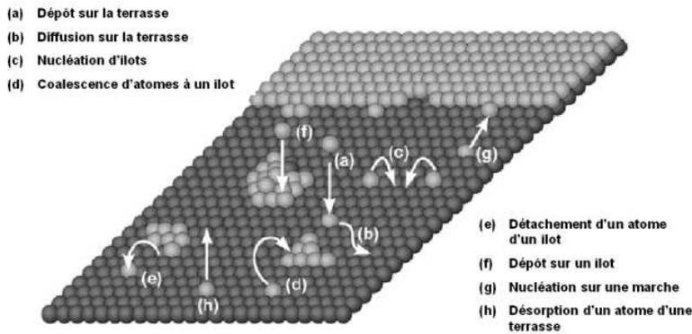
**Figure I-3 :** Représentation schématique des différents phénomènes se produisant lors d'une croissance épitaxiale menant à l'auto-assemblage d'îlots 2D avant la formation de la couche de mouillage [I-22].
