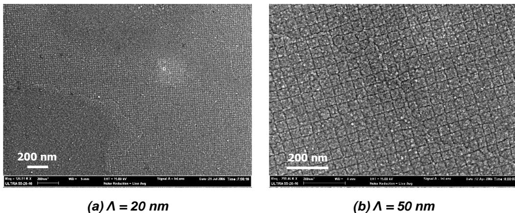
**Figure III-29 : Observations MEB de structuration de surface obtenue après une gravure chimique préférentielle Y7 sur un échantillon Tw de périodicité (a)  $\Lambda = 20 \text{ nm}$  et (b)  $\Lambda = 50 \text{ nm}$  menant la surface à 5 nm au dessous du plan du réseau de dislocations enterrées.**
