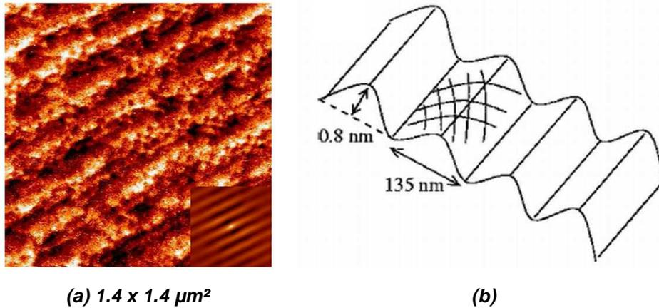
**Figure I-26 :** (a) Observation STM d'une surface d'un échantillon collé en torsion et flexion recuit à  $400^\circ\text{C}$  après oxydation sacrificielle. L'ins ert donne l'auto-corrélation de cette surface mettant en évidence la déformation de surface due au réseau de dislocations mixtes. (b) Représentation schématique de la structure de surface [I-78].
