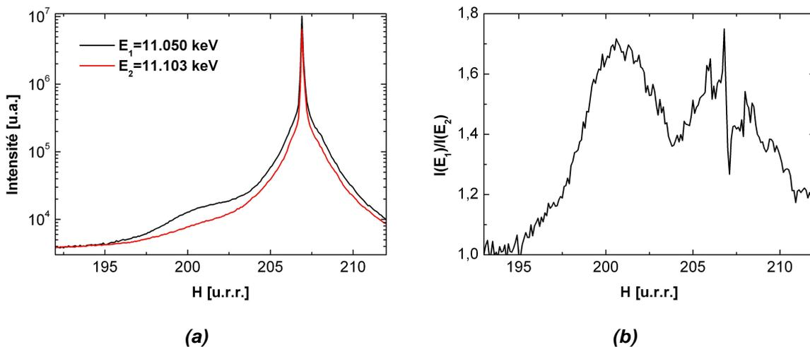
**Figure IV-17 : Balayage radial autour de la raie (440) sur le pic de la couche collée (autrement dit autour de la raie  $(H,K) = (201, -2)$ ) de l'échantillon présenté sur la Figure IV-14(b) pour deux énergies ( $E_1 = 11.050$  keV et  $E_2 = 11.103$  keV) au dessous du seuil d'absorption du Germanium. (b) Ratio des deux intensités en fonction de l'indice de Miller H du réseau réciproque du réseau de dislocations.**
