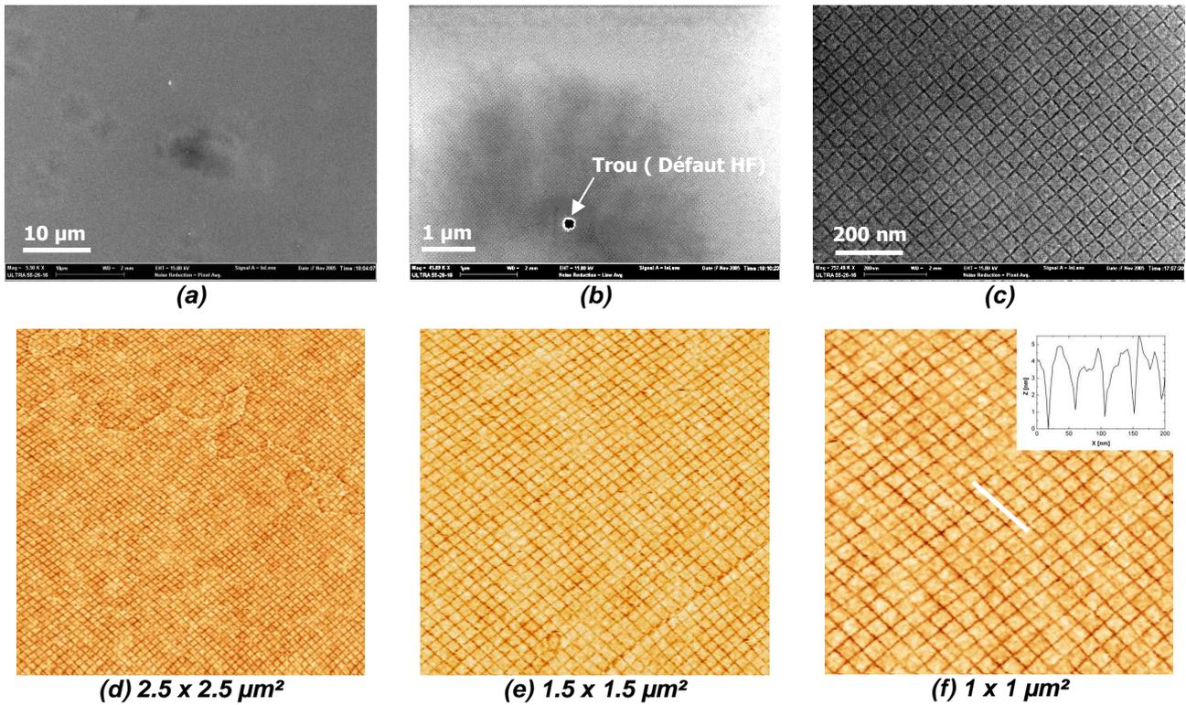
Figure III-17 : Observations MEB (a-c) et STM (d-f) de la surface nanostructurée ( $\Lambda = 50 \text{ nm}$ ) après une double gravure chimique préférentielle : Y7 + 3x3 min de gravure Dash pour différentes tailles d'observations. Le profil de la structuration indiqué en insert est mesuré au niveau du trait blanc.
