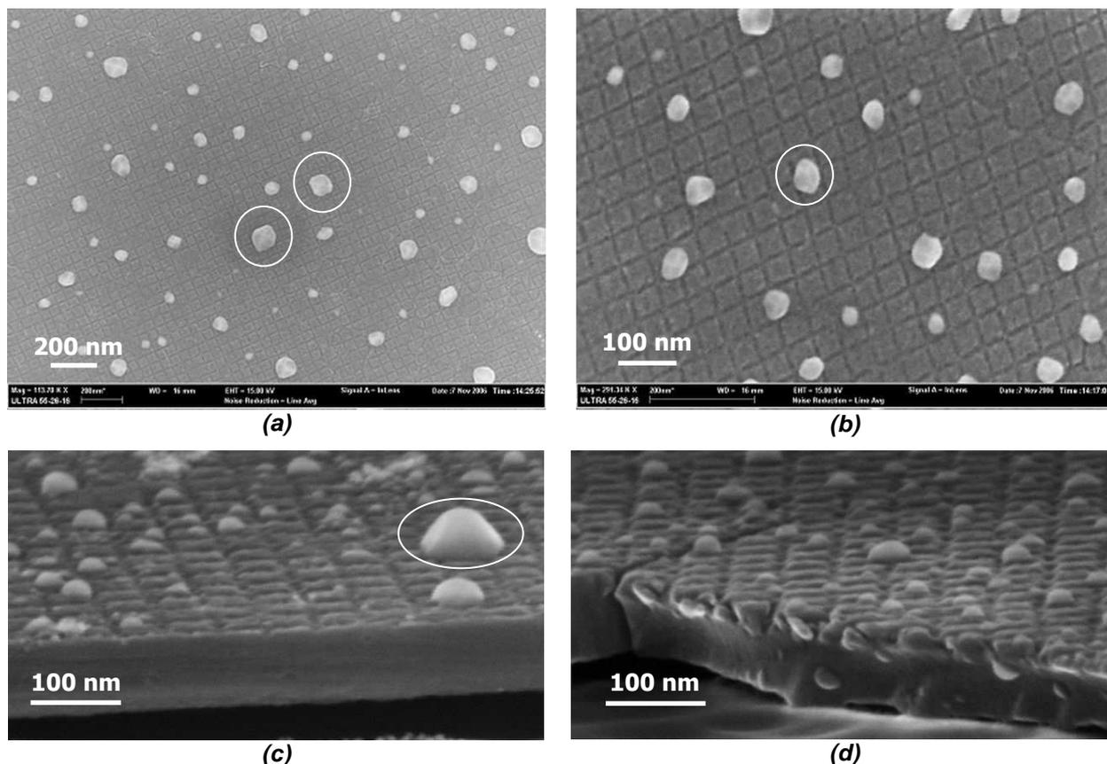
**Figure IV-24 : Observations MEB en vue plane (a-b) et désorientée (« tiltée ») en coupe (c-d) de la surface d'un échantillon TwSOI nanostructuré ( $\lambda = 50$  nm) après une croissance de 7 monocouches de Ge à 500 °C. Les cercles noirs indiquent quelques îlots de Ge facettés.**
