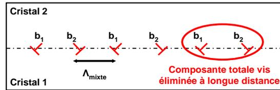
**Figure A9 : Représentation du joint de grain de flexion par des dislocations mixtes alternées et consécutives. Toutes les dislocations possèdent la même composante perpendiculaire à l'interface de collage mais avec l'autre composante qui change de signe lorsque l'on passe d'une dislocation ( $b_1$ ) à la suivante ( $b_2$ ) afin d'éliminer la composante totale vis et ainsi obtenir un comportement asymptotique (loin du cœur des dislocations) d'une dislocation coin pure.**
