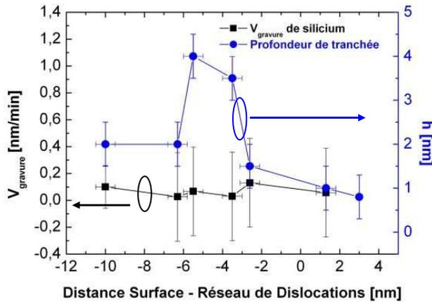
**Figure III-26 : (a) Evolution de la profondeur de tranchée et de la vitesse de gravure en fonction de la distance « Surface - Réseau de dislocations » au cours de la gravure chimique MD2 sur un échantillon TwSOI ( $\Lambda = 20$  nm) nanostructuré par une gravure chimique préférentielle Y7 amenant la surface à + 3 nm au dessus du joint de grain.**
