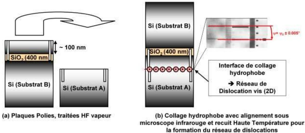
**Figure II-15 : Suite du procédé de fabrication : (a) Traitement HF vapeur suivi de (b) l'alignement des plaques sous microscope infrarouge et d'un traitement thermique haute température créant un réseau bidimensionnel de dislocations vis à l'interface de collage.**
