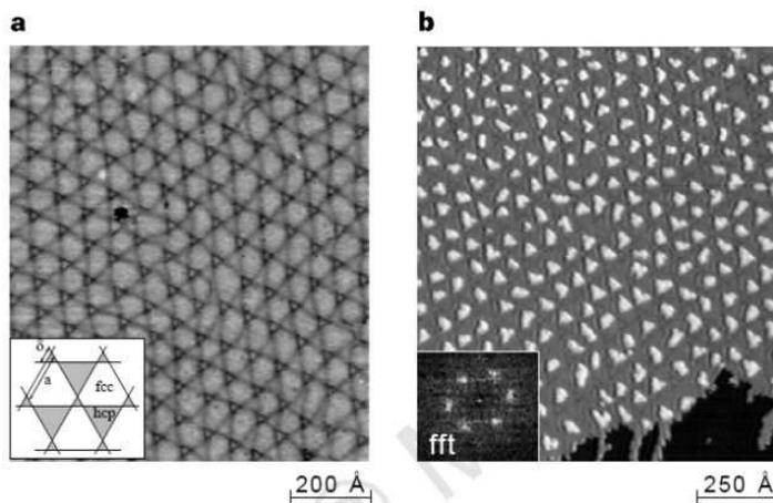
**Figure I-13:** (a) Réseau de dislocations de désaccord paramétrique à l'interface Pt (111) – Ag après le dépôt de deux monocouches d'Ag à 400 K suivi d'un recuit à 800 K. (b) Auto-organisation d'îlots d'Ag sur le même substrat après un dépôt supplémentaire de 0.1 monocouche à 110 K [I-48].
