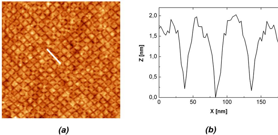
**Figure III-19 : (a) Observation AFM ( $700 \times 700 \text{ nm}^2$ ) d'un échantillon TwSOI nanostructuré ( $\Lambda = 50 \text{ nm}$ ) obtenue après une double gravure : Y7  $\rightarrow$  -3 nm + 3x3 min Dash. (b) Le profil de la structuration de surface obtenu au niveau du trait blanc en (a) indique des profondeurs de tranchées de l'ordre de 2 nm.**
