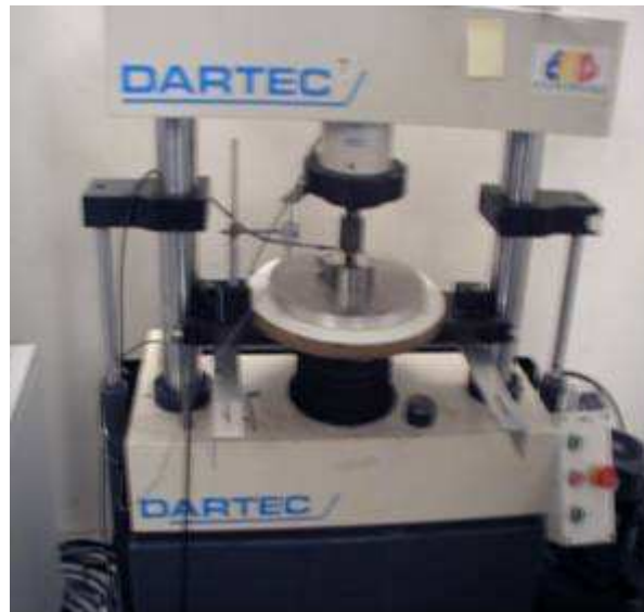
FIG. II.16 : Photo du dispositif de l'essai du retrait empêché.
