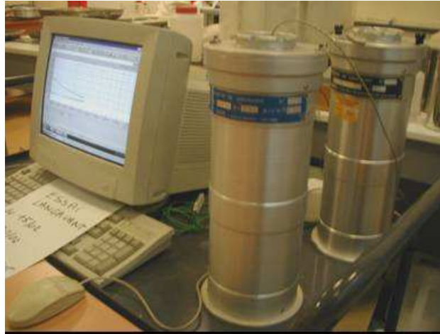
FIG. II.21 : Photo du dispositif de l'essai de la calorimétrie semi-adiabatique
