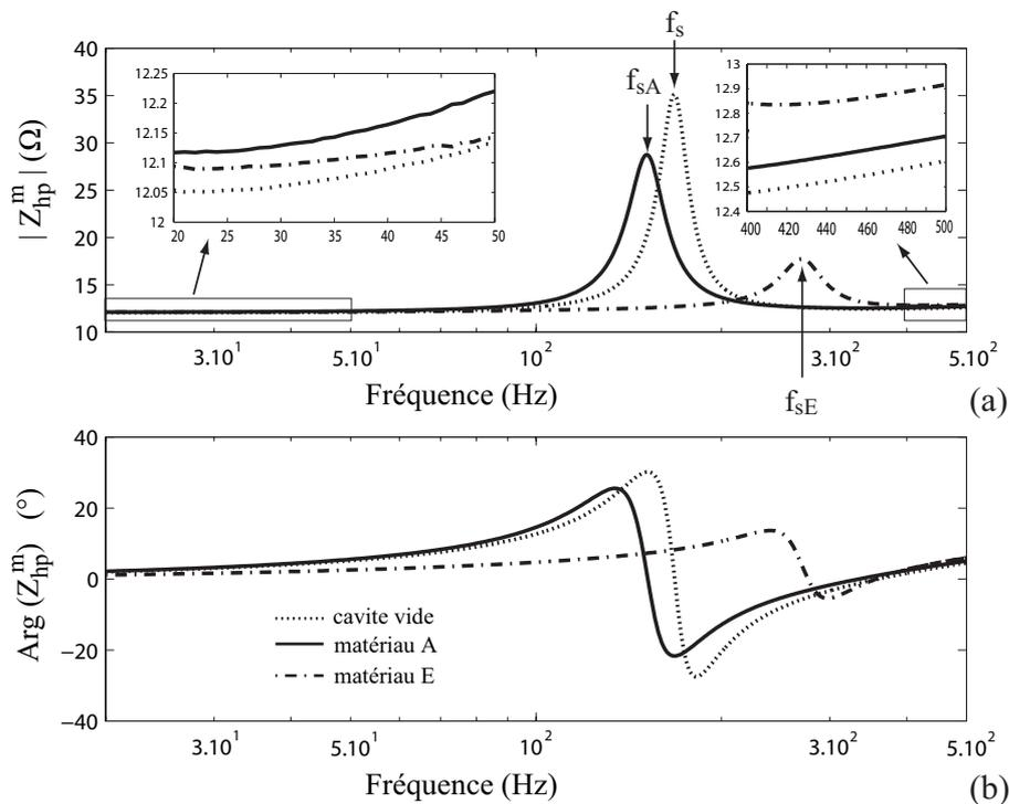
FIG. 7.10 – Impédance d'entrée du haut-parleur mesurée cavité vide et cavité garnie des trois matériaux A, B et E (Tab. 7.1): (a) module, (b) phase.
