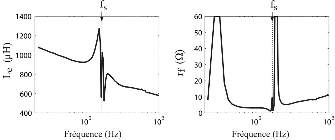
FIG. 7.8 – Évolution des paramètres recalés  $L_e$  et  $r_f$  avec la fréquence.
