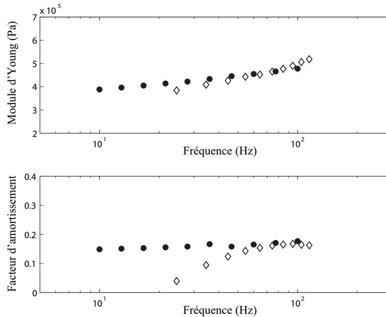
FIG. 7.12 – Estimations du module d'Young longitudinal  $E_L$  et du facteur de perte  $\eta$  pour la mousse  $E$  avec la méthode inverse basée sur la compression avec haut-parleur ( $\diamond$ ) pour une compression statique de 0.95% et comparaison avec la méthode quasistatique ( $\bullet$ ) pour une compression statique de 0.85%.
