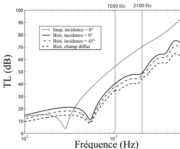
FIG. 3.6 – Étude de la perte par transmission ( $TL$ ) d'une double paroi sans lame d'air incluant la mousse C de 2 cm d'épaisseur et soumis à une excitation en onde plane pour différents angles d'incidence.
