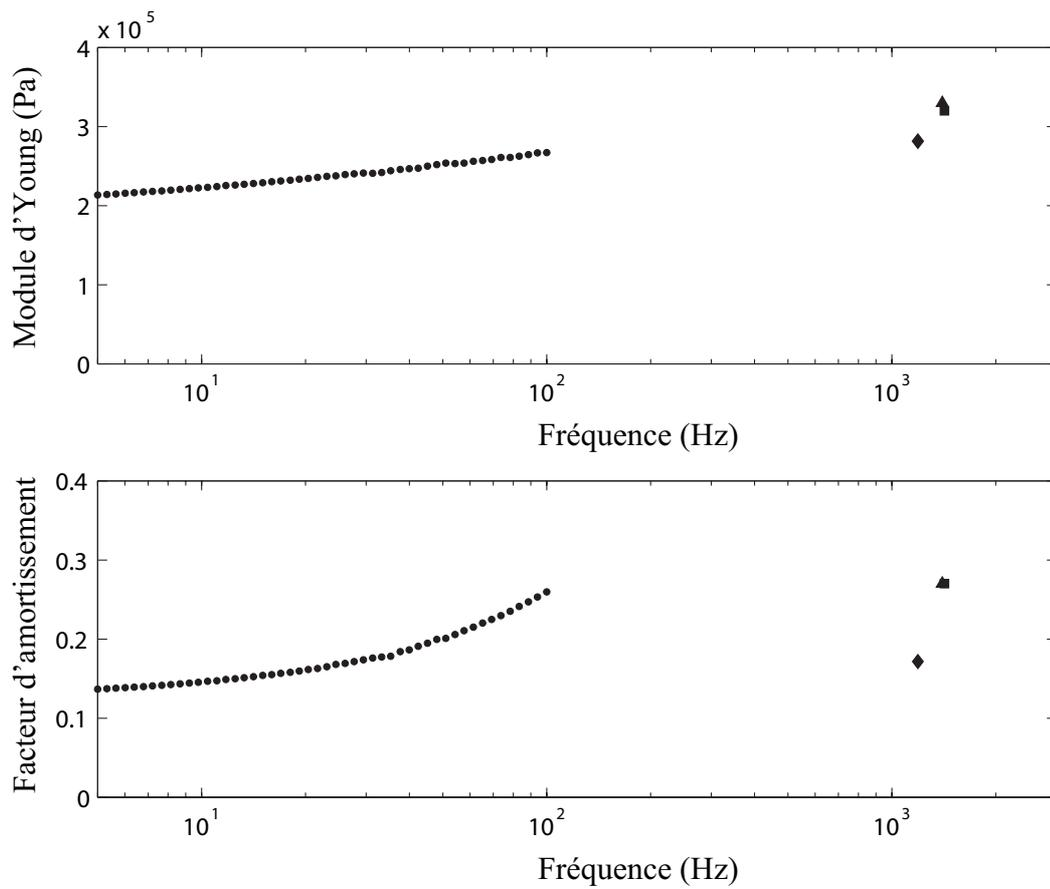
FIG. 6.12 – Estimations du module d'Young longitudinal  $E_L$  et du facteur de perte  $\eta$  pour la mousse C avec la méthode inverse basée sur le rayonnement de plaque ( $\blacklozenge$ ) et comparaison avec la méthode basée sur la transmission simple paroi ( $\blacksquare$ ), double paroi ( $\blacktriangle$ ) et la mesure quasistatique ( $\bullet$ ).
