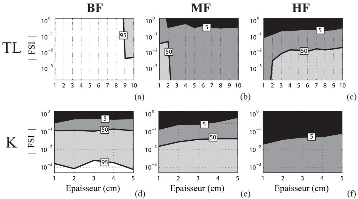
FIG. 3.5 – FSI limites dans les trois bandes de fréquences pour les configurations : (a-c) perte par transmission ( $TL_b$ ) du système double parois garni d'un poreux d'épaisseur de 1 à 10 cm, (d-f) impédance mécanique sur fond rigide pour un échantillon de poreux d'épaisseur de 1 à 5 cm.
