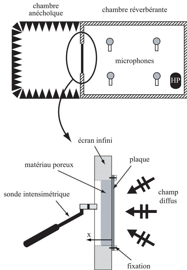
FIG. 5.2 – Schéma du montage expérimental de la mesure de transparence acoustique.
