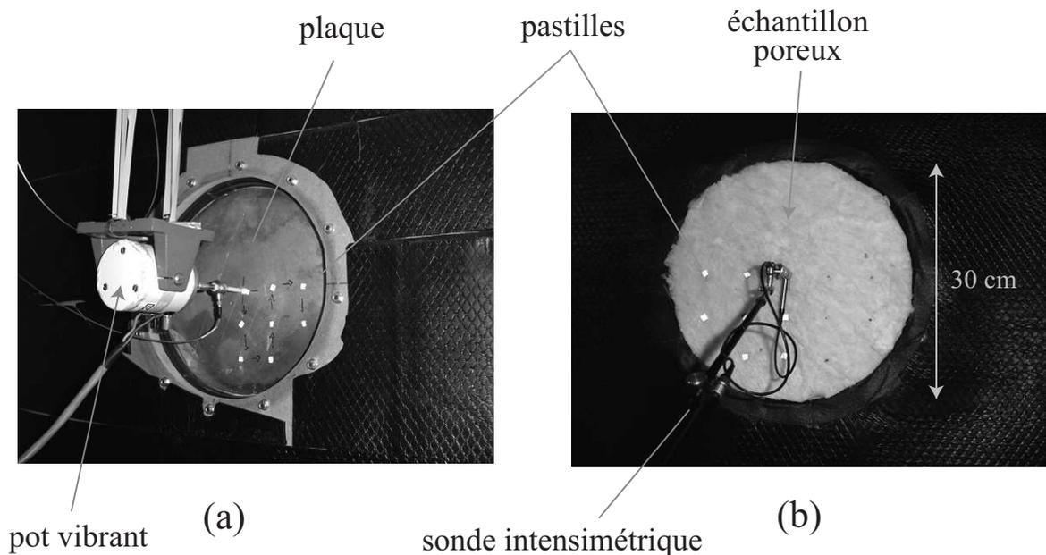
FIG. 6.8 – Photographie du dispositif expérimental pour la mesure du facteur de rayonnement d'une plaque circulaire encastrée : (a) côté excitation, (b) côté poreux.
