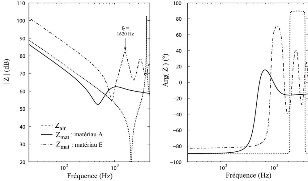
FIG. 7.6 – Impédances mécaniques  $Z_{mat}$  simulées pour une couche d'air et pour les deux matériaux poreux A et E présentés TAB.7.1. La surface est de  $1 \text{ m}^2$  et l'épaisseur de la couche de 40 mm.
