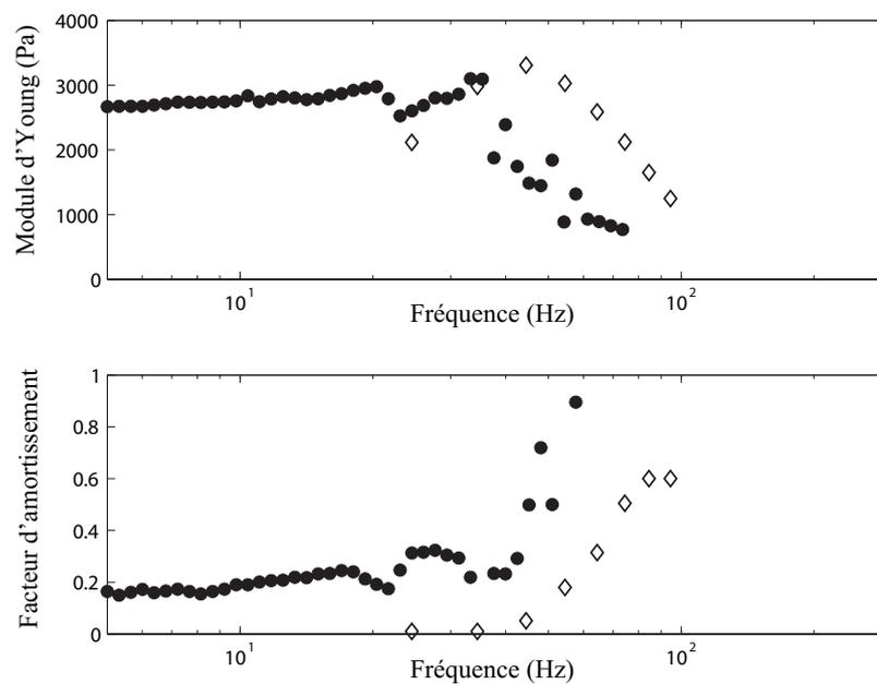
FIG. 7.13 – Estimations du module d'Young longitudinal  $E_L$  et du facteur de perte  $\eta$  pour le fibreuse  $A$  avec la méthode inverse basée sur la compression avec haut-parleur ( $\diamond$ ) et comparaison avec la méthode quasistatique ( $\bullet$ ), les deux méthodes sont effectuées à un taux de compression statique de 37%.
