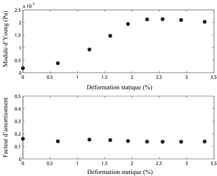
FIG. 4.3 – Module d'Young  $E$  et facteur d'amortissement  $\eta$  de la mousse polyuréthane C (voir TAB.5.1) mesurés à 5 Hz en fonction de la déformée statique  $\varepsilon_s$  pour  $\varepsilon_d = 0.02\%$ .
