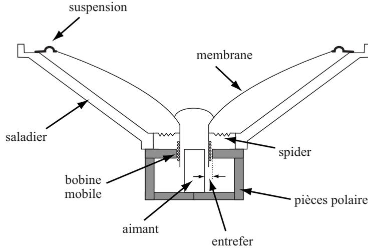
FIG. 7.2 – Structure mécanique d'un haut-parleur électrodynamique.
