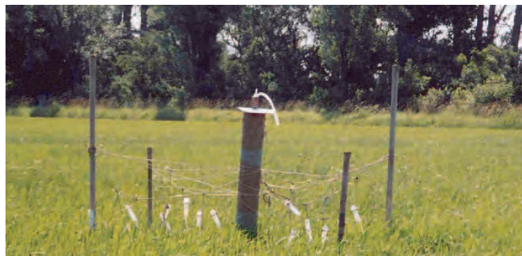
FIG. 4.13 – Flacons de prélèvements installés dans l'horizon hydrique du sol le 16/06/04. Photographie de Pierre Moreau.
