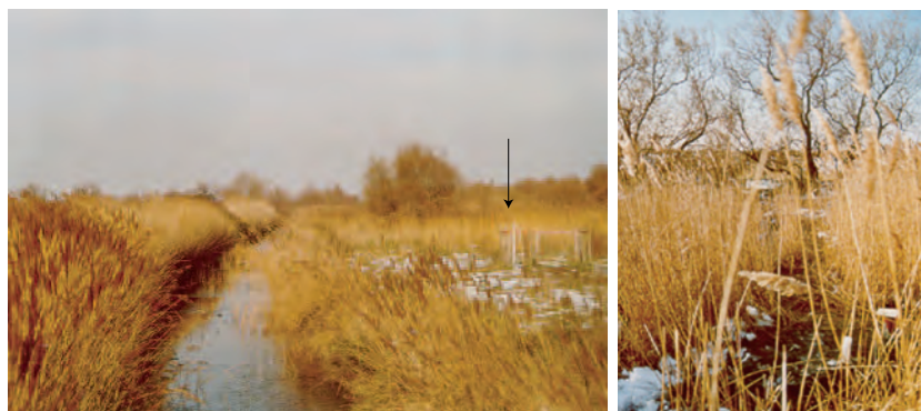
FIG. 1.1 – Première photographie : friche étudiée à droite du canal, le site est indiqué par une flèche. Seconde photographie : dispositif de mesure installé à 1,1 mètre de profondeur au milieu de phragmites, dont la localisation sur la photographie d'ensemble est indiquée par la pointe de la flèche.
