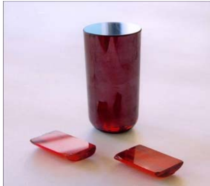
Figure 5 : Photographie d'un barreau de verre \text{Ge}_{20}\text{Ga}_5\text{Sb}_{10}\text{S}_{65}
