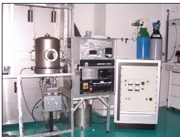
Photographie 1 : Bâti de pulvérisation cathodique au Laboratoire
