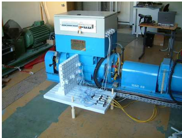
Fig. V. 20 Machine synchrone et son boîtier
