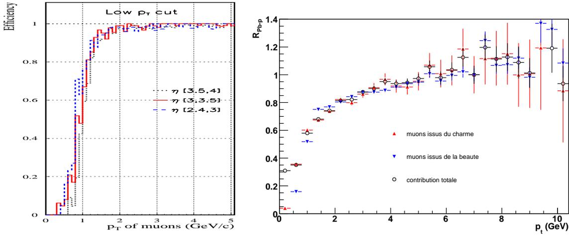
FIG. 7.23 – Efficacité du système de déclenchement en fonction de  $p_t$  (figure de gauche) et rapport des distributions des muons en tenant compte des coupures cinématiques et l’acceptance du spectromètre à muons (figure de droite).
