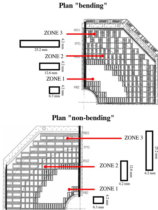
FIG. 4.3 – Segmentation des cathodes d'un quadrant de la Station 1 dans la direction de courbure et de non-courbure. Les trois zones de densité de pads y sont représentées ainsi que l'orientation des cathodes.
