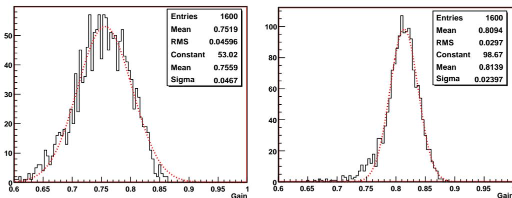
FIG. 5.10 – Distribution du gain. A gauche est représentée la distribution du gain mesuré à 184  $fC$  et à droite, la distribution obtenue avec un ajustement d'ordre 2 sur la dynamique de l'électronique testée. Les valeurs présentées sont le rapport de la tension de sortie et le signal de calibration. La capacité de calibration étant de 0.2  $pF$ , 0.7 correspond donc à  $3.5 \text{ mV} \cdot fC^{-1}$ .
