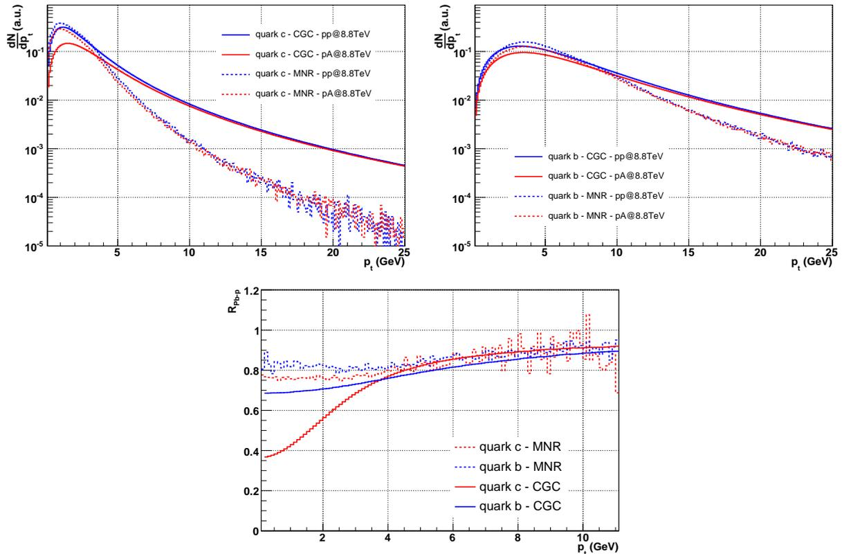
FIG. 7.17 – Distribution des quarks lourds  $c$  et  $b$  en fonction de l’impulsion transverse  $p_t$  en collisions proton-proton et proton-noyau. Les prédictions du modèle CGC sont représentées en traits plein et le modèle MNR en pointillé. La figure du bas représente le rapport  $R_{Pb-p}$  en fonction de  $p_t$ .
