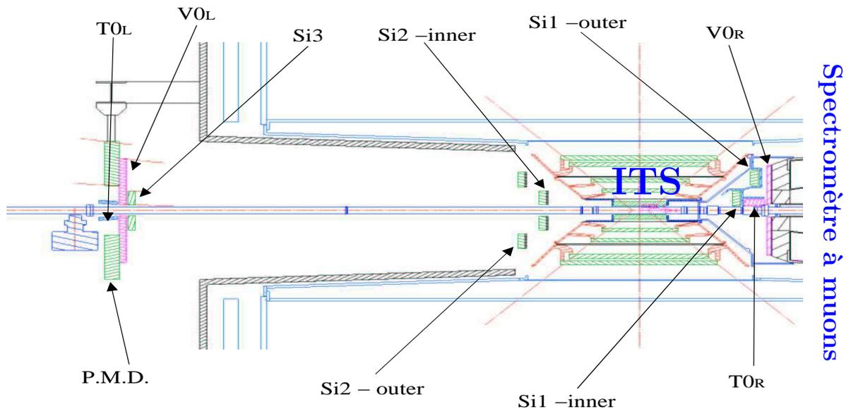
FIG. 3.10 – Disposition des détecteurs constituant le FWD de part et d'autre de l'ITS.
