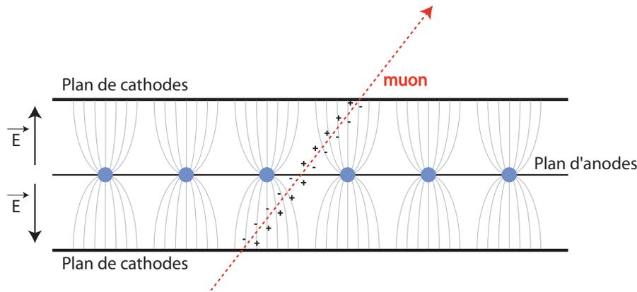
FIG. 4.1 – Ligne de champ et mécanisme d’ionisation des chambres à cathodes segmentées.
