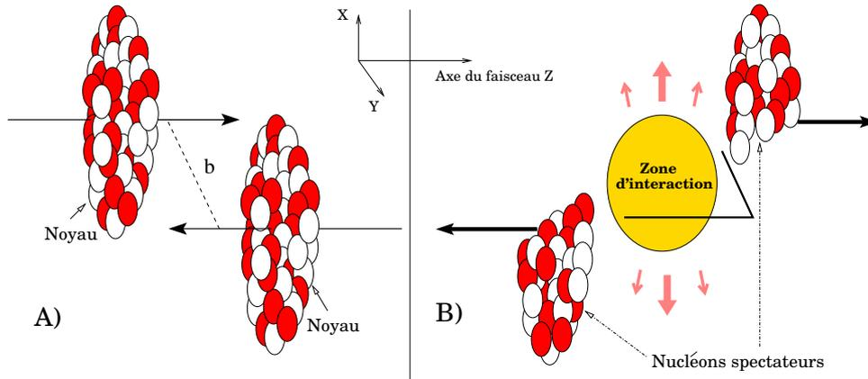
FIG. 2.8 – Représentation d'une collision d'ions lourds.  $b$  désigne le paramètre d'impact.
