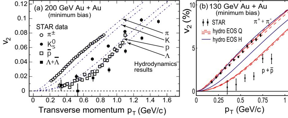
FIG. 2.13 – A gauche : évolution du  $v_2$  en fonction du  $p_t$  et de la masse des particules. A droite : comparaison des prédictions du modèle hydrodynamique pour un PQG (EOS Q) et un gaz hadronique (EOS H) avec les données expérimentales en proton et pion de STAR pour des collisions Au-Au à 130 GeV.
