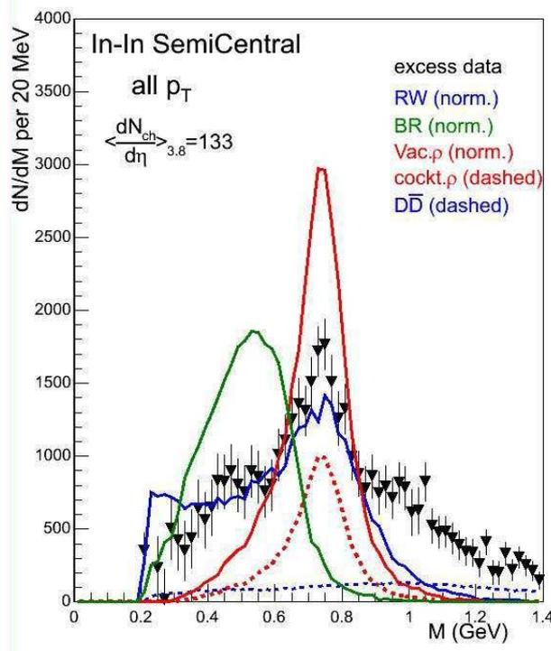
FIG. 2.19 – Comparaison de la masse invariante du méson  $\rho$  mesurée par l’expérience NA60 avec les prédictions des différents modèles théoriques tenant compte de la restauration de la symétrie chirale. En trait “plein-fin” est indiquée la masse de la résonance en l’absence de restauration de la symétrie, en trait “plein-épais” en cas d’élargissement et en “pointillé-point” en cas de décalage de la masse.
