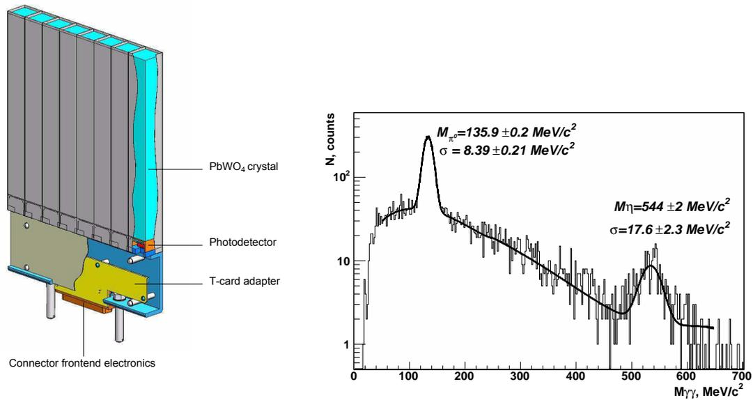
FIG. 3.9 – Module élémentaire du détecteur PHOS et résultat de simulations de mesure de la masse invariante des  $\gamma$ -jets.
