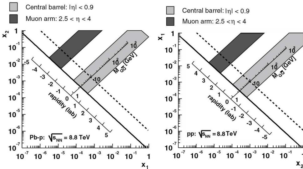
FIG. 7.13 – Domaine d'acceptance du détecteur ALICE en fonction des fractions d'impulsion  $x_1$  et  $x_2$  dans le cadre des collisions Pb-p (à gauche) et p-p (à droite) à 8.8 TeV. Les seuils de production des paires  $c\bar{c}$  et  $b\bar{b}$  sont respectivement indiqués en trait plein et en tirets.
