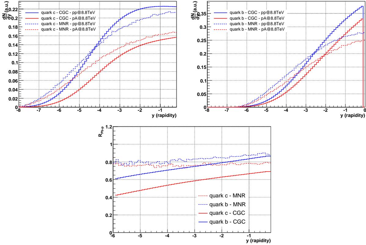
FIG. 7.16 – Distribution des quarks lourds  $c$  et  $b$  en fonction de la rapidité en collision proton-proton et proton-noyau. Les prédictions du modèle CGC sont représentées en traits plein et le modèle MNR en pointillé. La figure du bas représente le rapport  $R_{Pb-p}$  en fonction de la rapidité.
