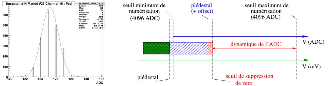
FIG. 6.1 – A gauche : distribution du piédestal sur l'une des voies de lecture du spectromètre. A droite : représentation du niveau du piédestal, du seuil de suppression et de la dynamique de l'ADC en fonction de la charge. En vert est représenté le niveau du piédestal, en bleu le piédestal avec un offset de 100mV et en rouge le bruit à  $3\sigma_e$ .
