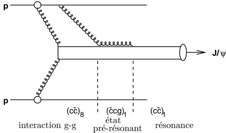
FIG. 2.22 – Mécanisme de production d'un onium via le modèle octet de couleur.
