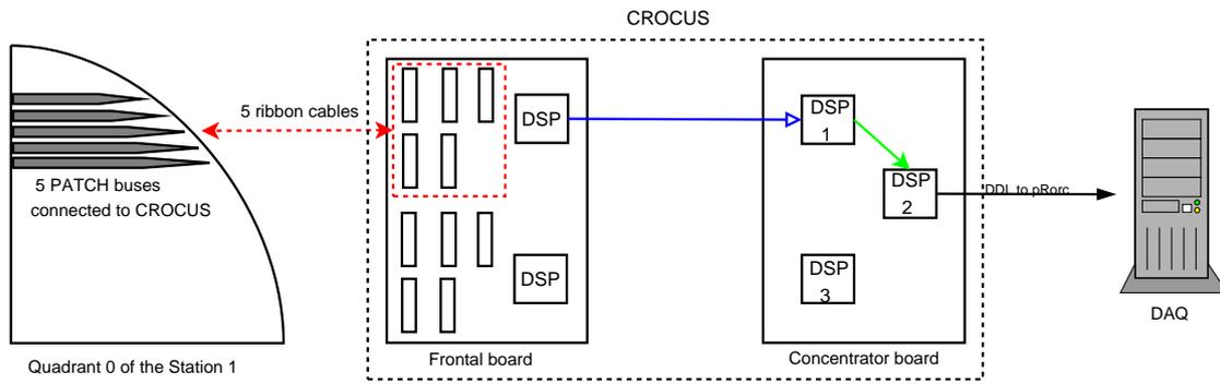
FIG. 5.2 – Configuration CROCUS utilisée en juillet 2004.
