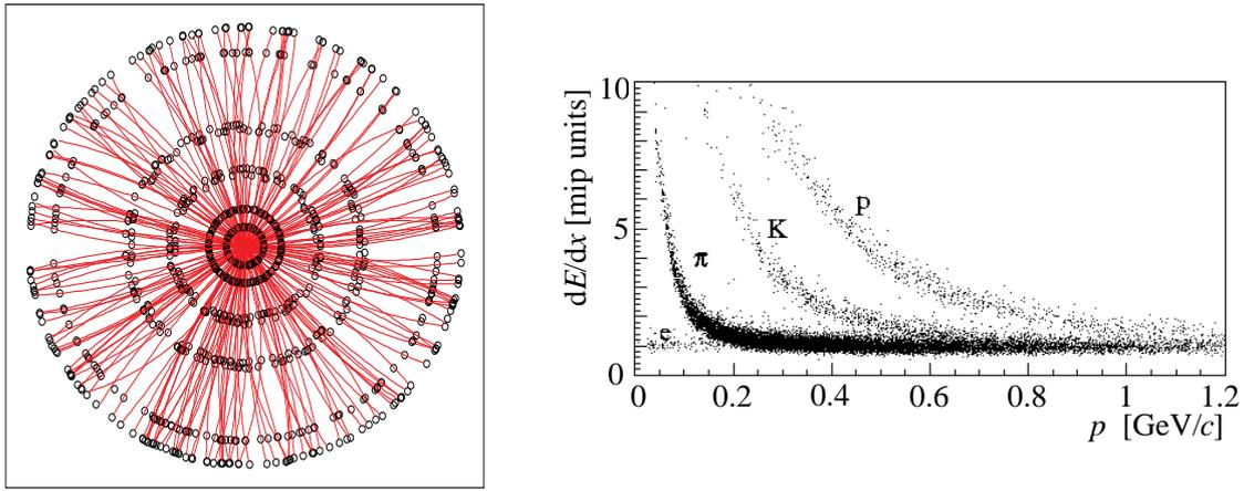
FIG. 3.4 – À gauche : exemple de reconstruction d'un événement dans l'ITS en utilisant les informations fournies par la TPC. À droite : graphe de corrélation entre la perte d'énergie mesurée par l'ITS en fonction de l'impulsion de différentes particules.
