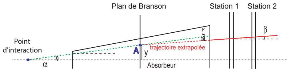
FIG. 4.11 – Principe du plan de Branson.
