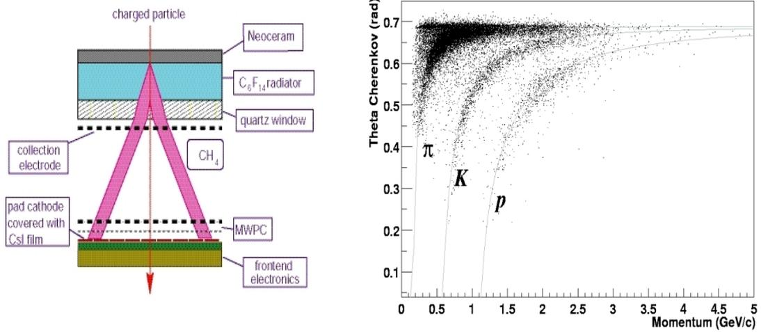
FIG. 3.8 – A gauche : coupe transverse des modules du HMPID. A droite : graphe de corrélation entre l'impulsion et l'angle du cône de lumière en fonction du type de particules chargées.
