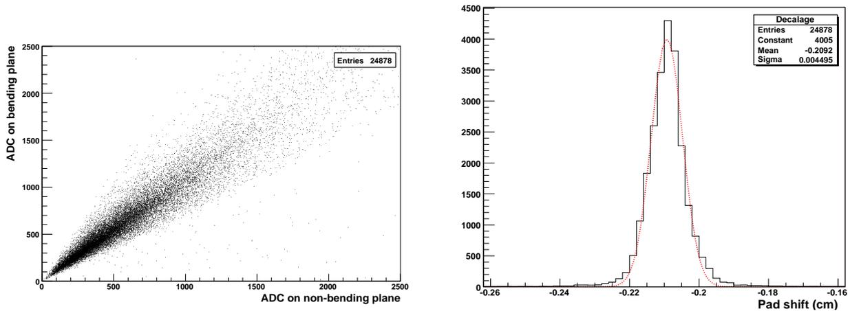
FIG. 5.12 – À gauche : corrélation de charge entre le plan *bending* (équipé de MANAS) et *non-bending* (avec GASSPLEX). À droite : décalage des segments de cathode (cm) entre le plan *bending* et *non-bending* dans la zone de grande densité de segments. L’histogramme montre la différence de la position du point d’impact calculée sur chaque plan : on y retrouve le décalage des pads entre les deux plans.
