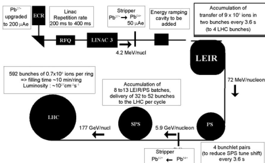
FIG. 3.2 – Séquence d'accélération des noyaux de plomb.
