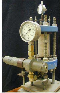
FIG. 1.15 – Essai de compression - éprouvette cylindrique
