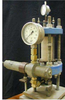
FIG. 1.15 – Essai de compression - éprouvette cylindrique
