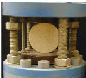
FIG. 1.18 – Essai de traction indirecte (essai brésilien)
