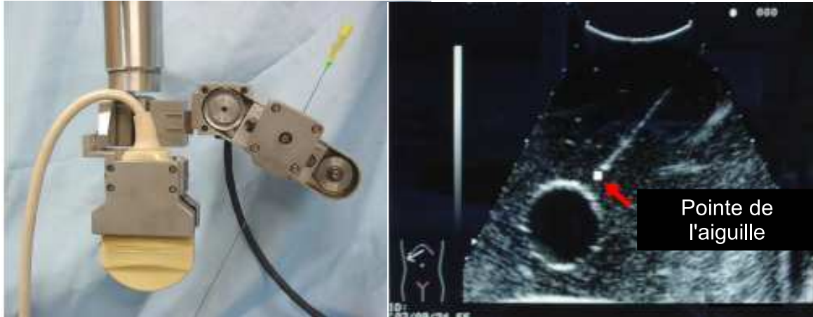
FIG. 14 – Système de guidage d'instrument asservis sur des images échographiques [Hong 2004]
