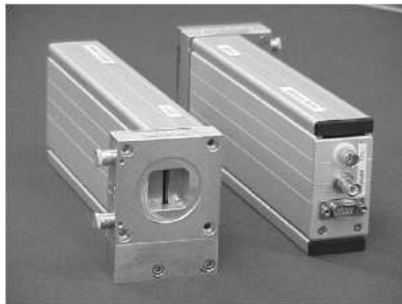
Figure A.I.9 : Détecteurs utilisés sur la ligne de lumière BM29, appelés détecteurs CZT (car composé en CdZnTe), on distingue la fente avant motorisé à gauche et la connectique permettant d'alimenter l'unité et de récupérer les informations issues de celle-ci [6].
