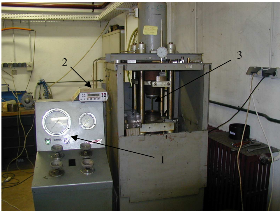
Figure I.10 : Presse (type Basset) utilisée pour la génération de la pression dans la pompe B18 pour la mesure ultrasonore sous basse pression. 1 : Manomètre et vumètre de contrôle de la montée et de la descente de pression. 2 : Multimètre pour la mesure de la résistivité de la jauge de manganine (mesure interne de la pression). 3 : Contre piston pour la compression du pentane dans la pompe B18.
