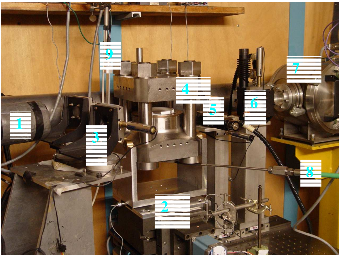
Figure A.I.7 : Dispositifs de la station de diffraction X en dispersion d'énergie au L.U.R.E (ligne DW11). 1 : détecteur Germanium ; 2 : porte cellule et empilement des moteurs ; 3 : fentes arrière ; 4 : Presse Paris Edimbourg ; 5 et 6 : fentes avant ; 7 : fentes refroidies ; 8 : capillaire d'arrivée d'huile de compression, 9 : photodiode.
